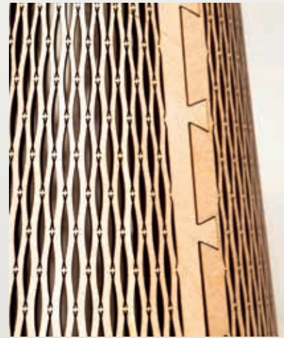
4. ábra: a lámpabura palástjának összeillesztése fecskefarkú fogazással
