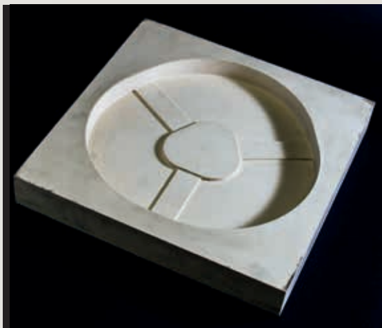
3. ábra: a betontalp öntőformája
