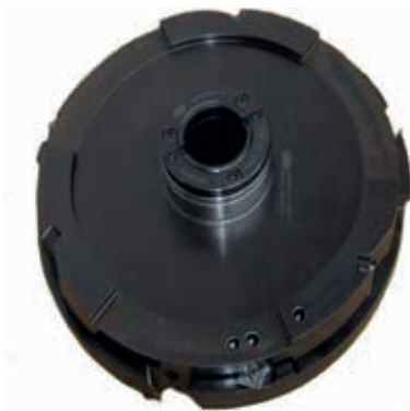
6. sz. kép: 92-es ablakszárny végprofilozó körkéses marófeje, és a csapozó szerszám
