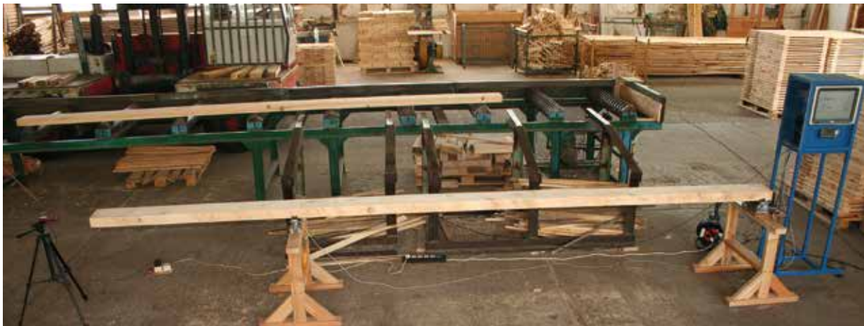
A SOE Roncsolásmentes Faanyagvizsgáló Laboratóriumában kifejlesztett PLG+ szilárdsági osztályozó berendezés
