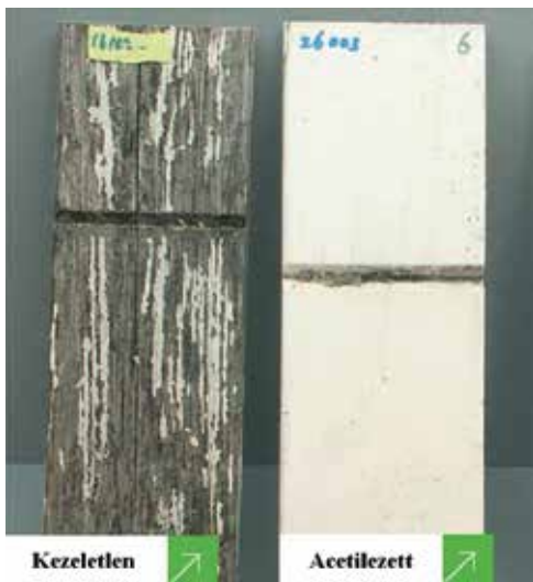
Kilenc és fél évnyi kitettség után sem kellett az acetilezett faanyagot újrafesteni (forrás: SHR, Hollandia)
