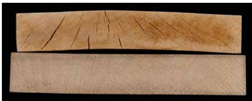
Gyertyán (felül) és acetilezett gyertyán (alul) vízben való áztatás és hirtelen szárítás után (forrás: Pozsgayné)
