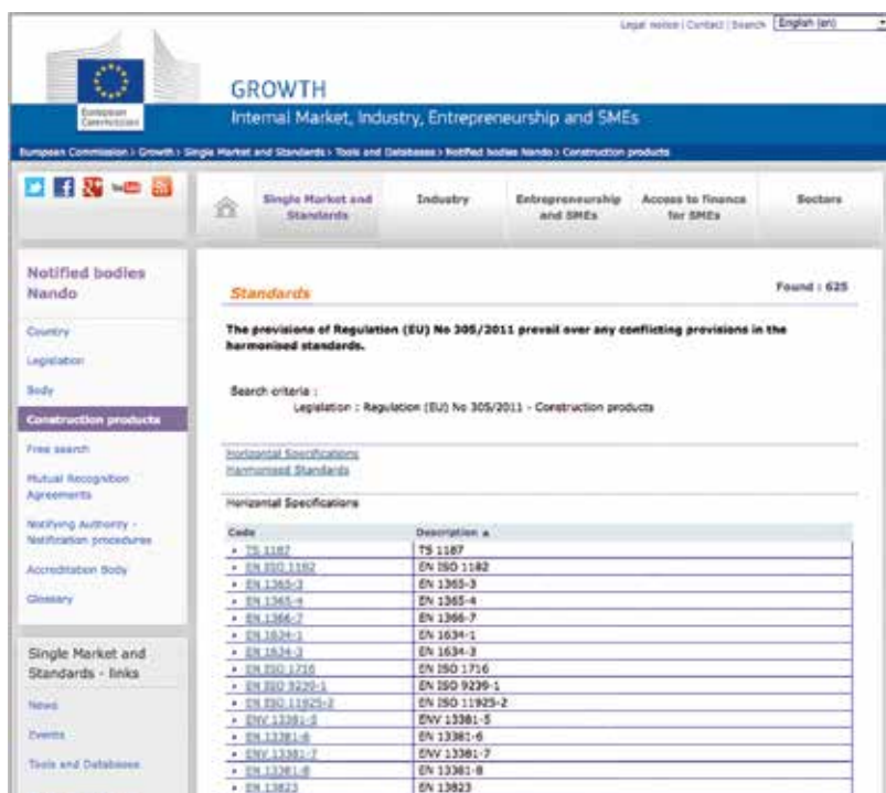
2. ábra: az építési termékek (Construction products) rendeletével harmonizált szabványok listázhatók a NANDO-adatbázisból
