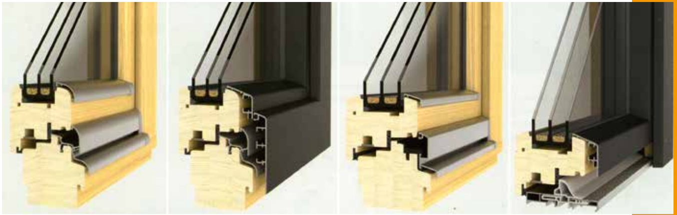
Legkorszerűbb fa ablakszerkezetek háromrétegű, gázos töltésű üvegezéssel. 1-2 U = 0,91; 4-4 U = 0,74 W/m 2 K
