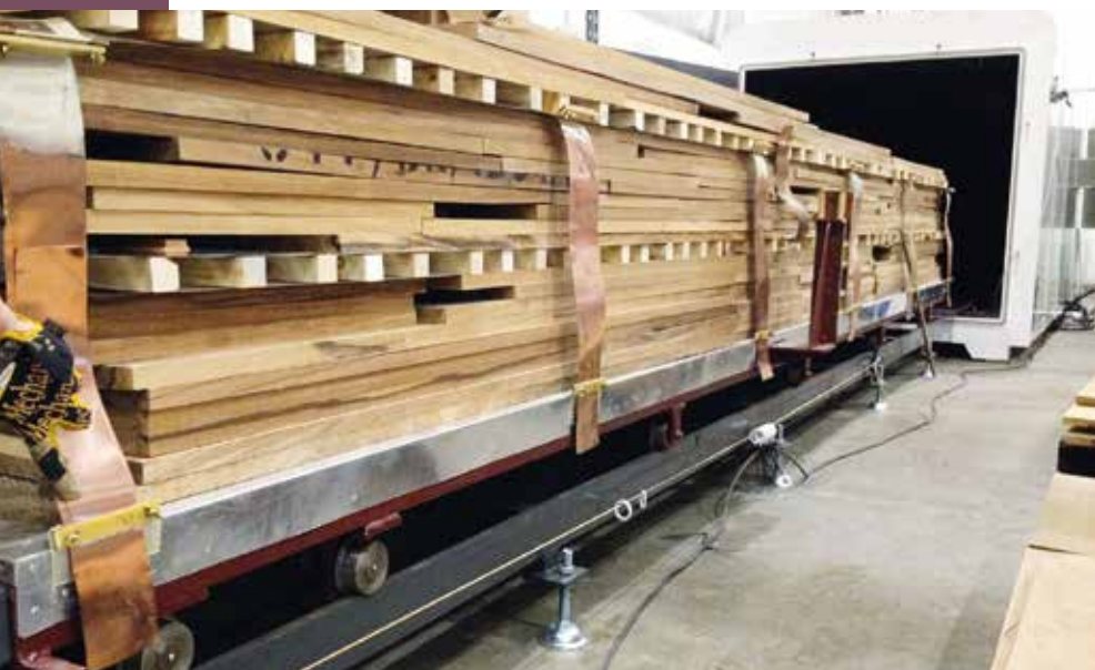
A berakodást segítő sínes rendszer
