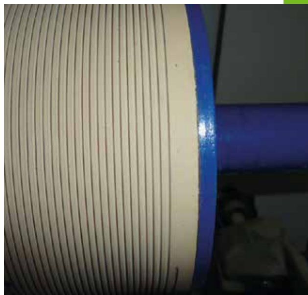
Bordázott henger ragasztó felhordására (Csiha Cs.)
