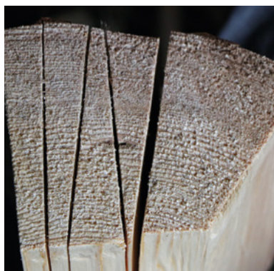
Egy cikkelyből 10–12 db zszindely hasítható
