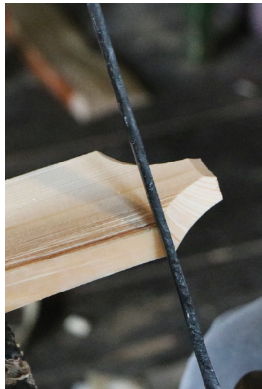
Vonókéssel elkeskenyíti a zszindely végét
