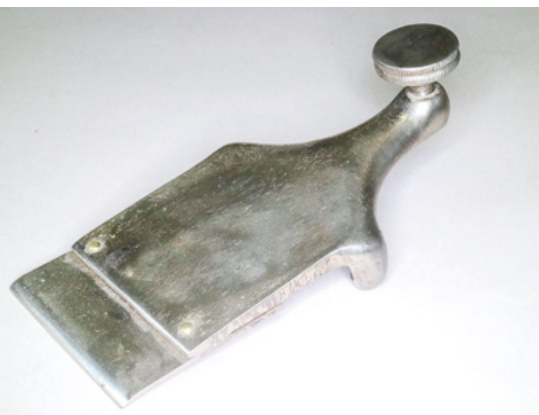
A klipszre szegecselt acéllemez forgácstörő
