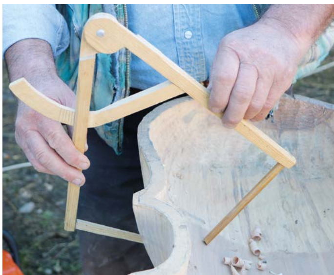
Vastagság mérése saját maga által készített szögmérővel
