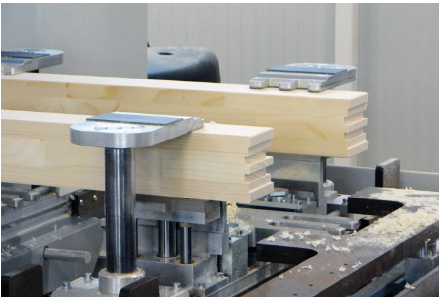
A stabil rögzítés is erőssége ennek a CNC megmunkálóközpontnak
