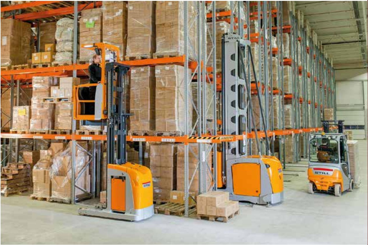
A komissiózó targonca az áru begyűjtésben nyújt segítséget
