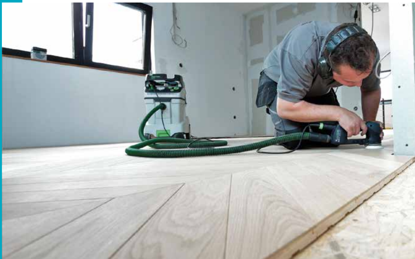
Áttételes hajtású excenteres csiszológép munka közben
