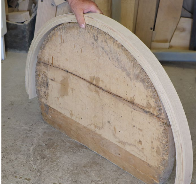
Az agy szilfából, a küllők akácából és a talpak kőrisfából készülnek
