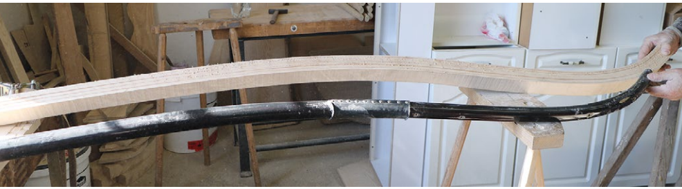
A kocsirúd tömbösített alapanyaga 9 réteg juharfából és egy elkészült rúd
