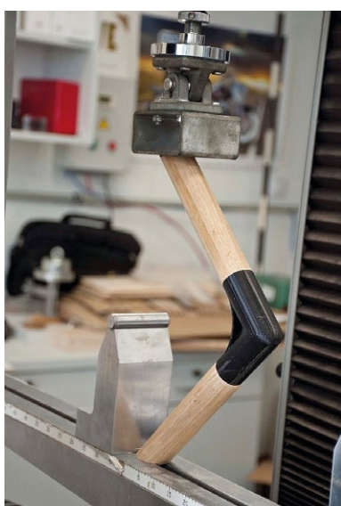
8. ábra: sarokkötés szilárdsági vizsgálata
