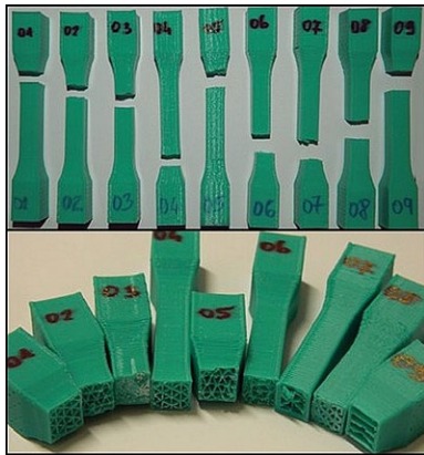
5. ábra: a húzóvizsgálatok során kapott törésképek (Forrás: Bagi Bettina)
