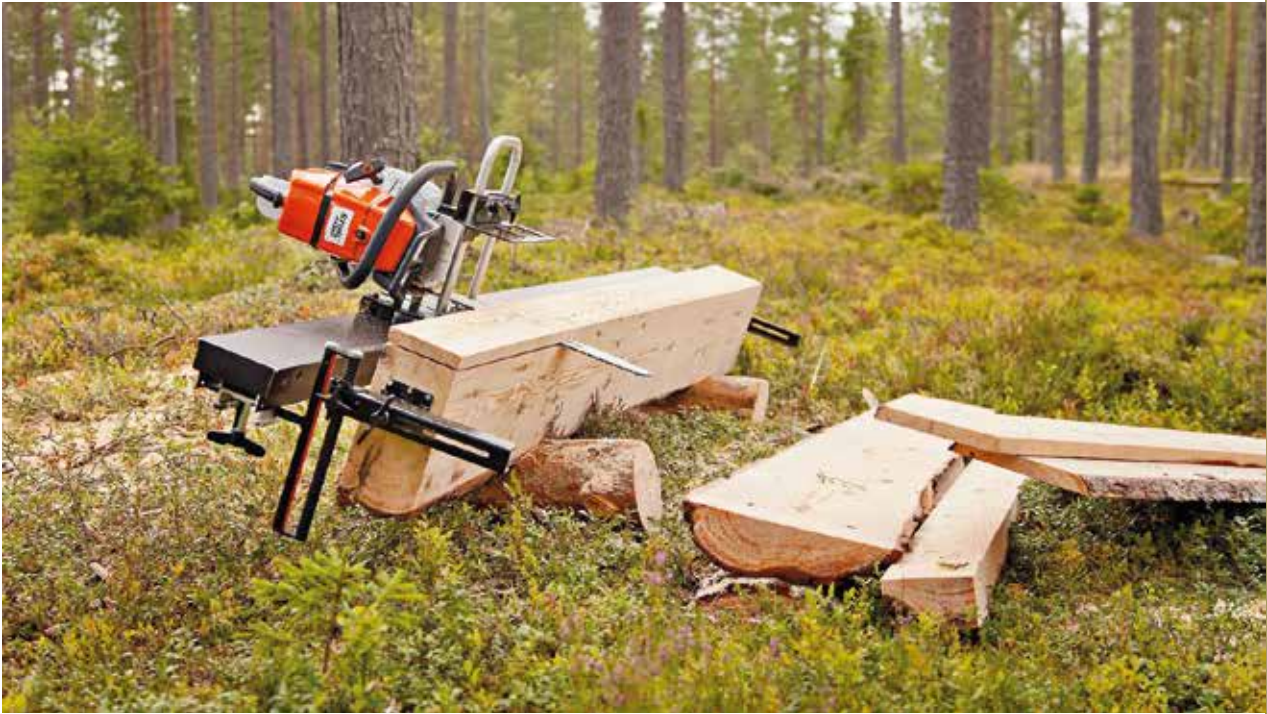
A vezetősínes vágókeret a földön fekvő fűrészelt anyagot vagy a rönköt is jól kezeli
