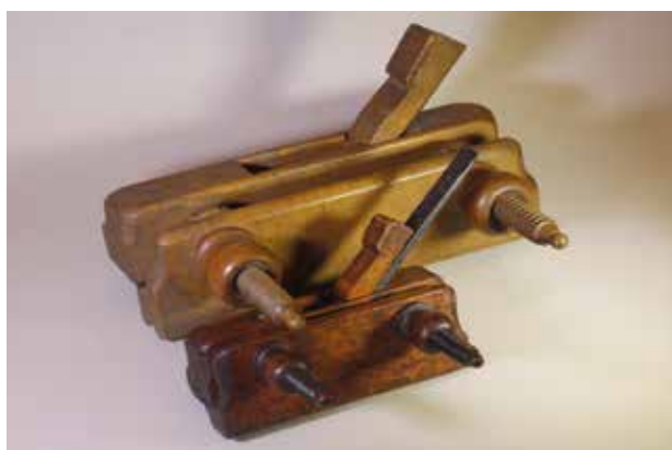
A tökéletesen kidolgozott mini árokgyalu alig fele a gyári szárnak
