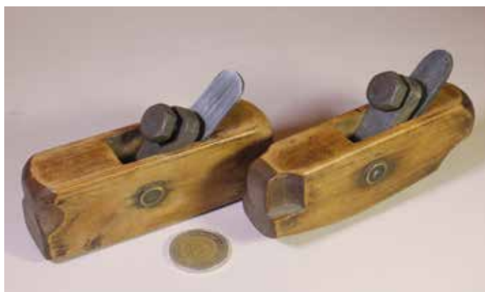
Egyedi gyártású hangszerkészítő gyaluk
