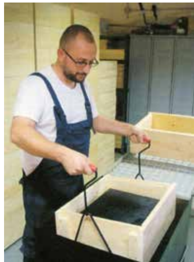
Az elemek felületkezelése 90 fokos olajban és 5 percig történik
