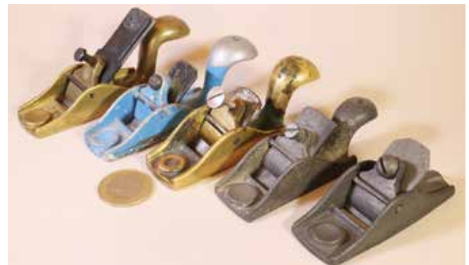
Stanley No. 100 és 101 kópiák bronzból, vasból és alumíniumból
