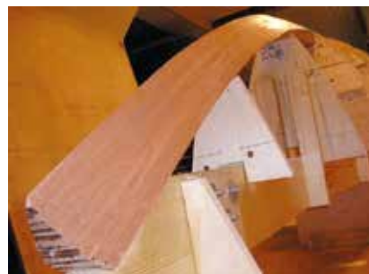
Rétegtechnika első furnérjának szabása
