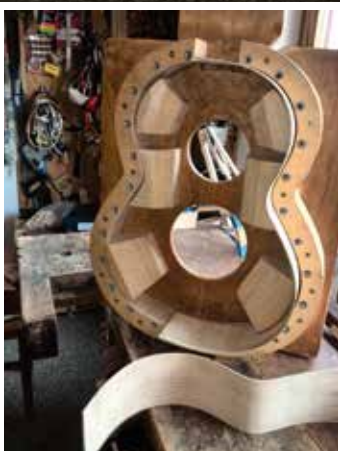
Készülő gitár, oldallap hajlítása sablonban, ragasztóléc a hát és oldallap összeragasztásához
