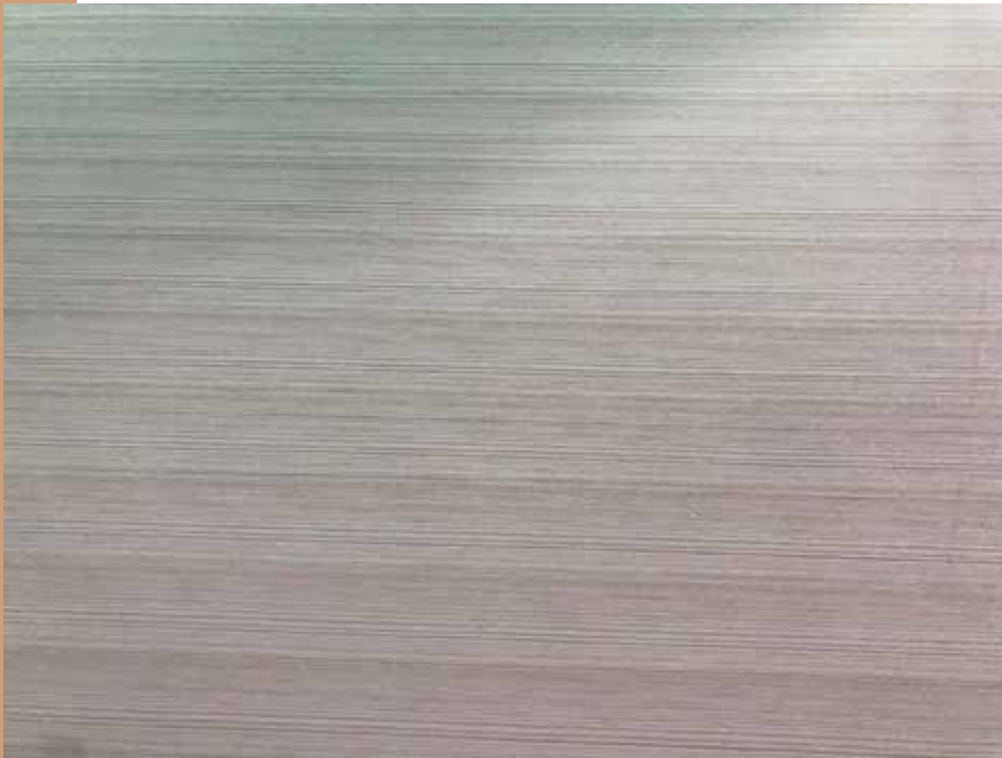
A kétszer késelt borovi rétegelt lemez homogén felületet ad (borovi-fenyő.hu)
