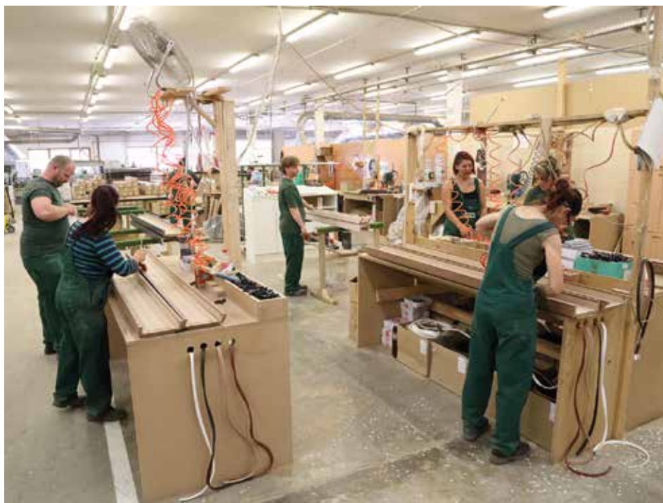
Pánt- és gumiprofil-elhelyezés valamint minőség-ellenőrzés
