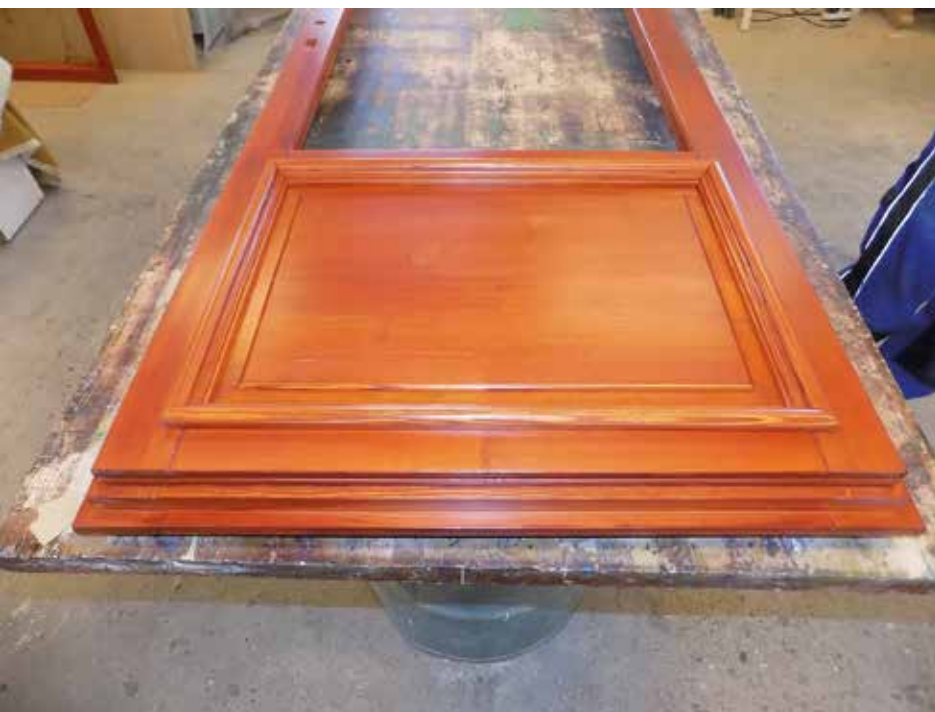
68 mm-es europrofilos nyílászáró, szélesség- és hosszoldott alapanyagokból (A szerző saját felvétele.)
