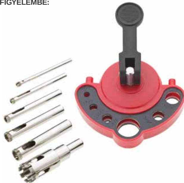
Égetett kerámia fúrásánál az ütvefúrás helyett használjunk gyémánt fúrószárat és fúrószárvezetőt
