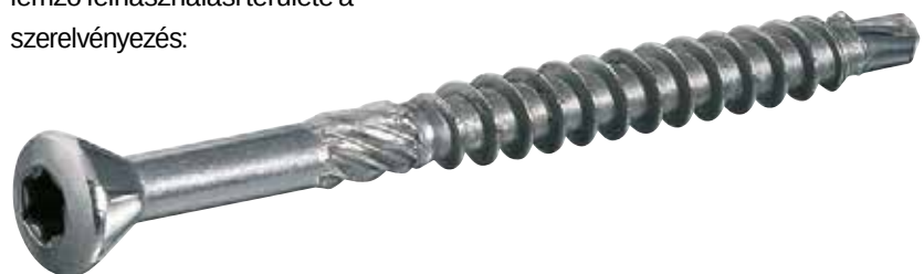
Fúróhegygel ellátott teraszépítő csavar: a Torx fej segíti a nyomatókátvitelt, a kialakítás a forgácskihordást
