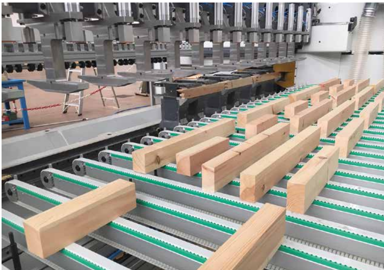
CNC-adagoló manipulátorral és anyagmegfogókkal
