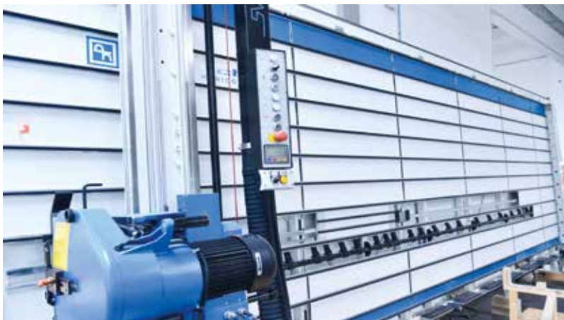
A függőleges lapszabásgép egyszerűen üzemeltethető és extra hosszú kivitelben is kapható
