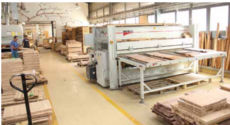
A hőprézés táblásítás és a kontaktcsiszolás itt történik
