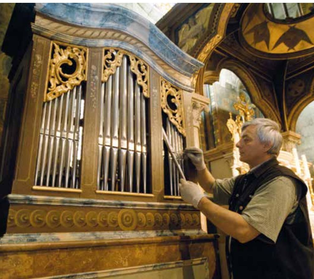
Műszaki értelemben a különféle orgonák elkészülhetnek a műhelyben, de a sípok hangzását a helyszíni akusztikához állítja be
