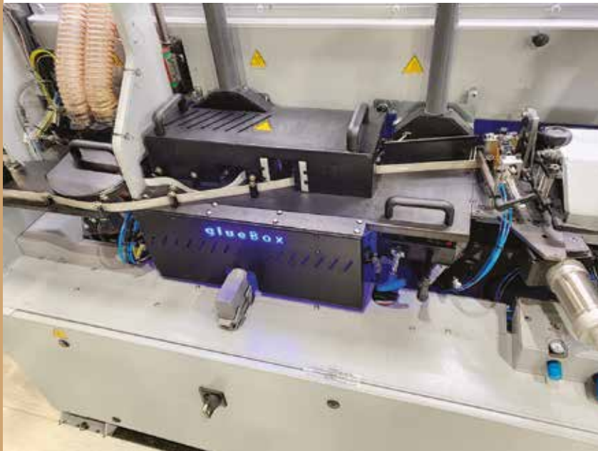
Enyvtartály helyett ragasztócsíkokkal történik a szinte fuga nélküli illesztés
