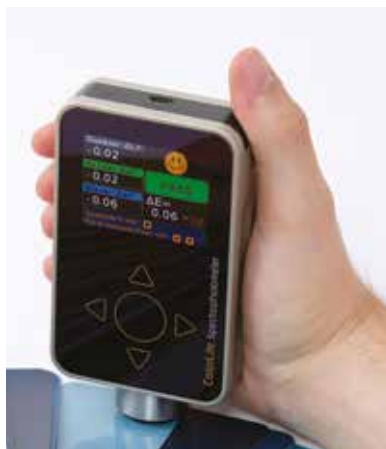
Spektrofotométerrel színt azonosíthatunk, ellenőrizhetünk, továbbá színeltérést mérhetünk
