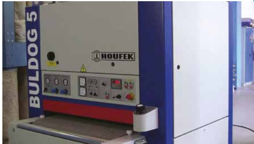
A kontaktcsiszoló gép robusztus szerkezet, ami többféle opcióval és számos különböző megmunkálási szélességgel rendelhető
