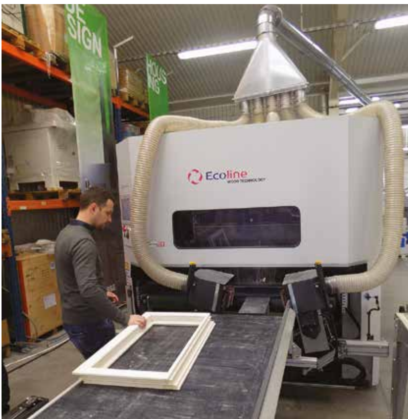
Speciális ablakkeret-csiszoló, ami külső és belső élek megmunkálására is képes
