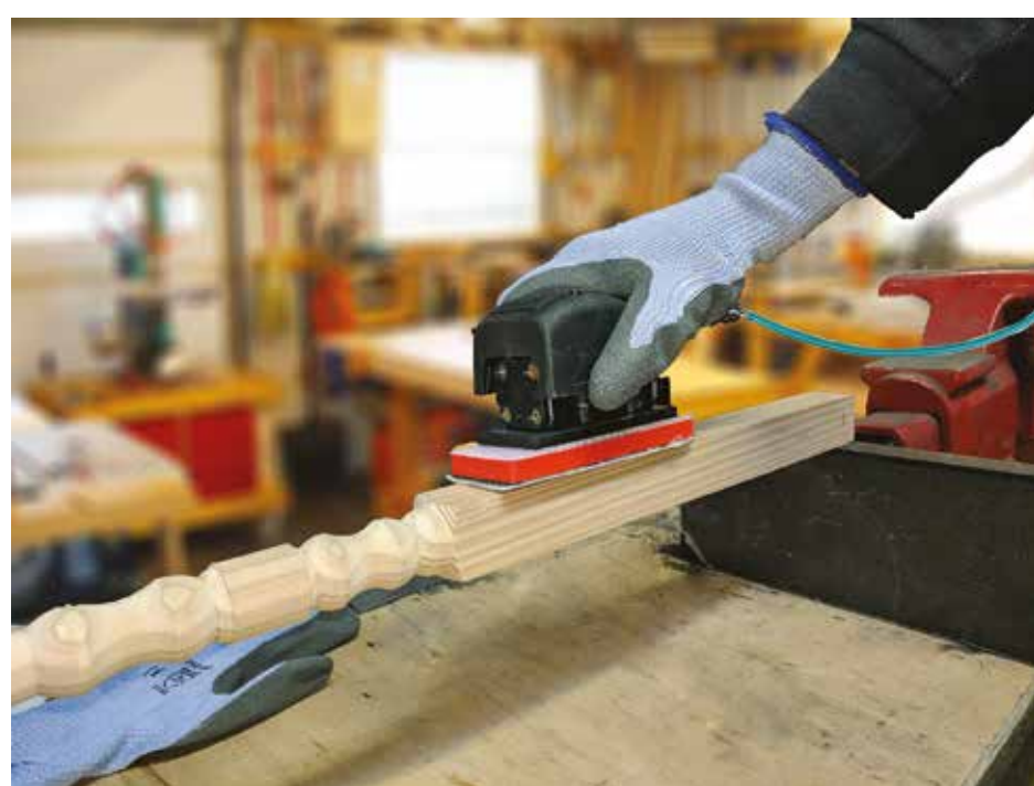
A felületkezelés alapja a megfelelő csiszolással történő előkészítés
