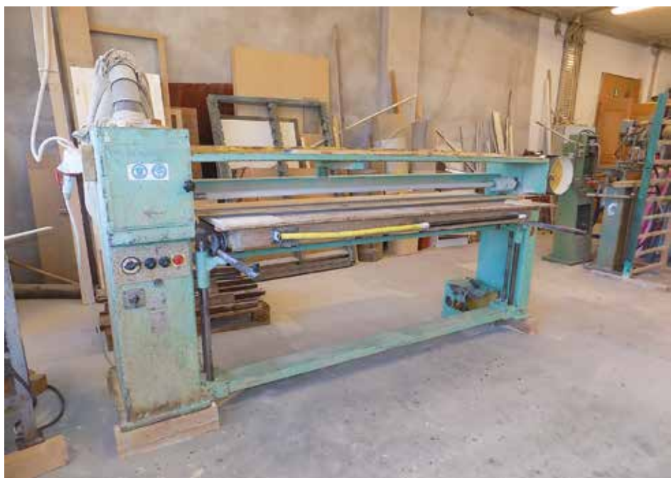
A keskenyszalagos csiszoló egyszerű és megbízható szerkezet, a képen látható példány 1975 óta üzemel
