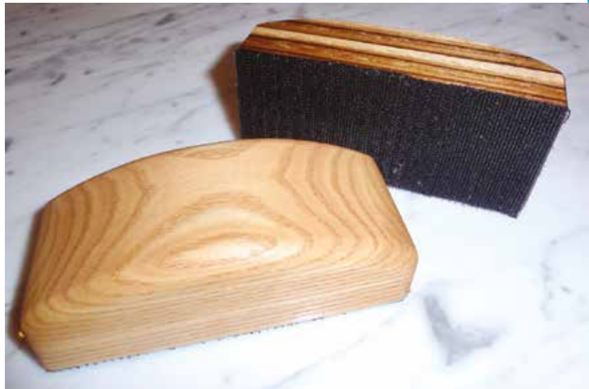
Csiszolófa kialakítása tépőzáras csiszolóanyagokhoz
