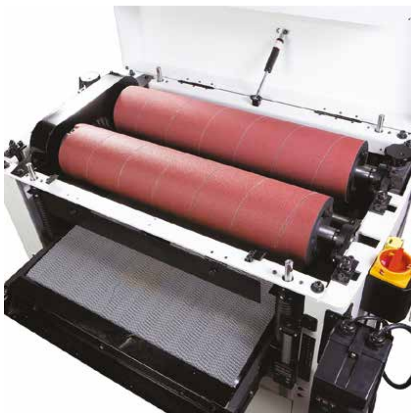
Kéthengeres csiszológéppel gazdaságos és pontos munka végezhető
