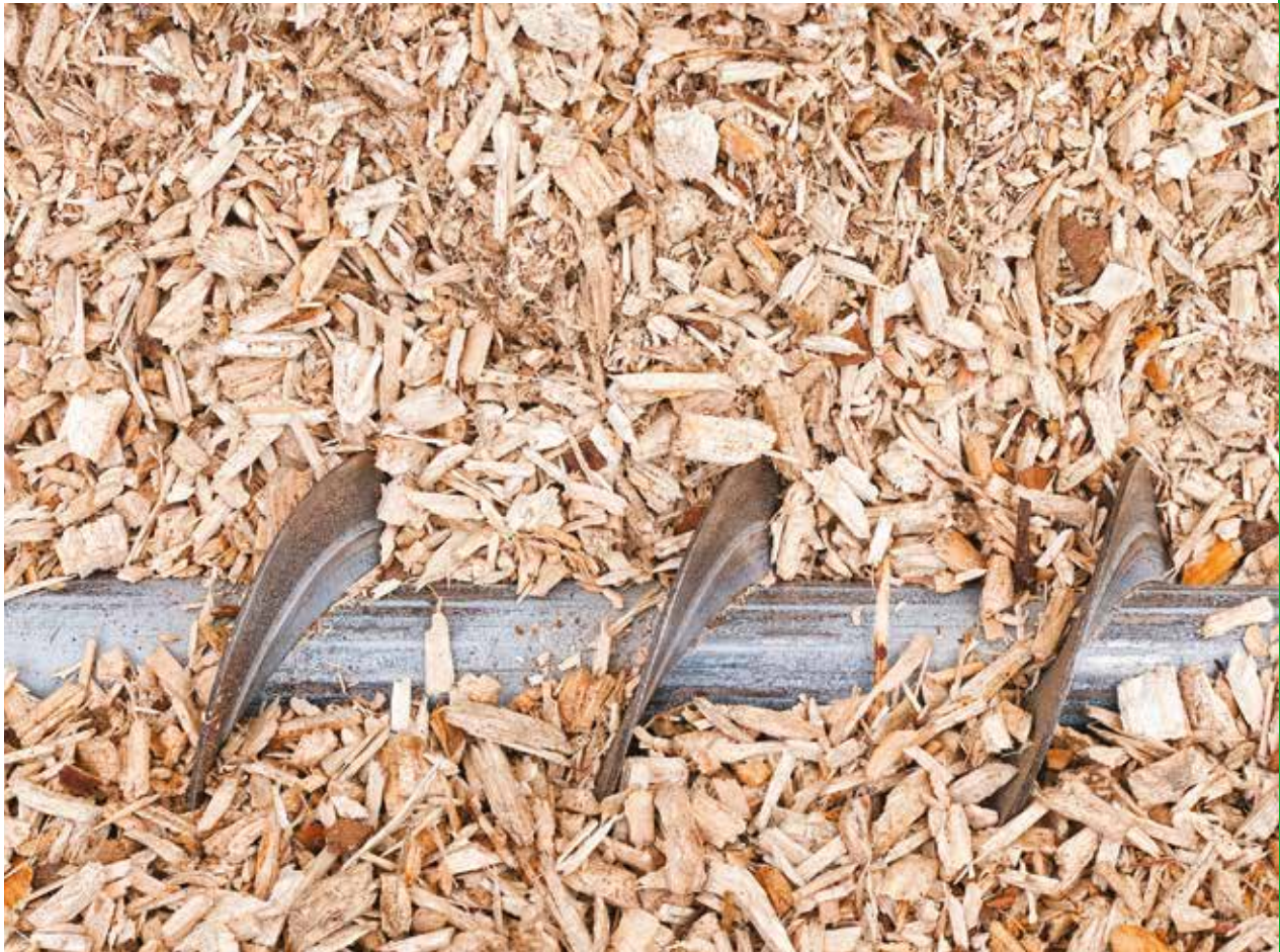
Faapríték kazán táplálását végző csigás adagoló
