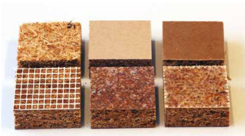
A felszínen elhelyezett papír, üvegháló és szövet-megerősítések
