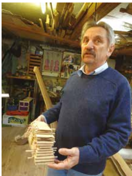
A rezonáns alapanyaga csökkenő vastagságban és hosszúságban
