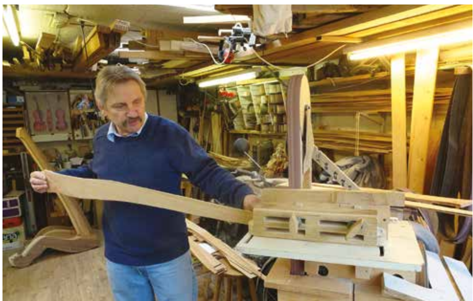
A saját készítésű univerzális csiszológép
