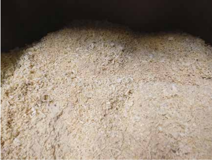
Általában vegyes, forgácsból és fűrészporból álló aprítékkal üzemeltetjük.
