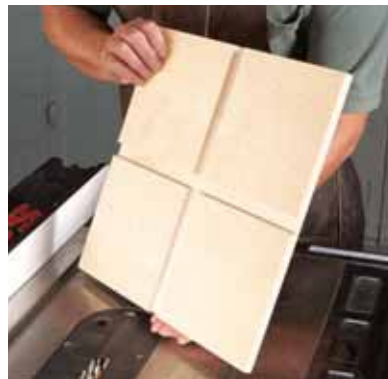
2. Vágjunk két derékszögű hornyot a négyzet alapú rétegelt lemezbe! Ez lesz a sablon alapja.
