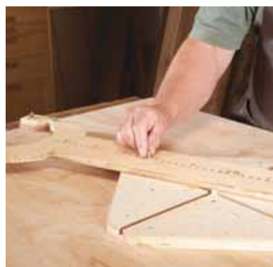
12. Rögzítsük a kart a rövidebb tengelyhez kapcsolódó csúszkához! Húzzuk ki a csúszkát a jobb szélre, addig, amíg a lyuk a megfelelő furat alá kerül, majd csavarozzuk le!
