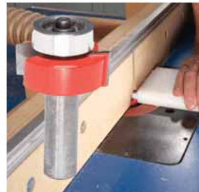
3. Marógépen a műanyag mindkét oldalát munkáljuk meg egy T alakot formázva!
