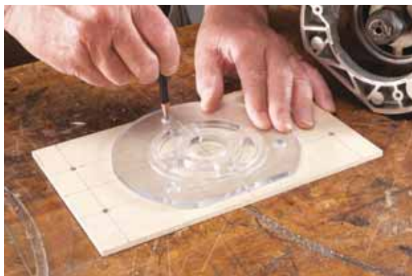
9. Készítsünk kétféle talpat a vezetőkarhoz! Az egyik a felsőmaróhoz lesz rögzítve, a másik a ceruzával való rajzolást teszi lehetővé
