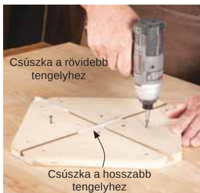
10. Rögzítsük a marósablon vázát a munkadarabhoz! A csúszkákat állítsuk a megfelelő pozíciókba!
