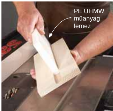
1. A sablon hornyolásához használjunk horonymaró (dado) körfűrészlapot, hogy a 20 mm vastag UHMW műanyag precízen illeszkedjen a horonyban!
