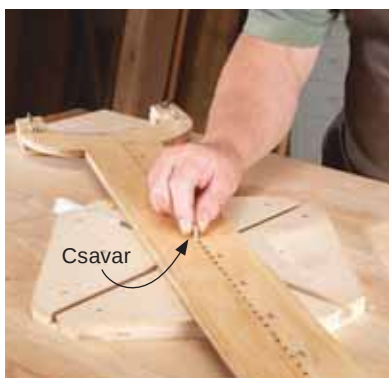
11. Rögzítsük a kart a hosszabb tengelyhez kapcsolódó csúszkához! A karon lévő beosztásoknak megfelelő lyukon keresztül csavarjuk be a csavart a csúszkába!
