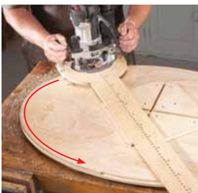
14. Szereljük fel a marótalpat, majd a felsőmarót! Az óramutató járásával ellentétesen haladva többször marjuk körbe az ívet, fokozatosan mindig mélyebbre engedve a marószárat!
