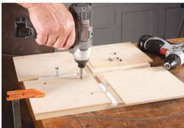
6. Tegyük a csúszkákat a horonyba, majd helyezzük rá a négy darab rétegelt lemezt (C) és rögzítsük le őket!
