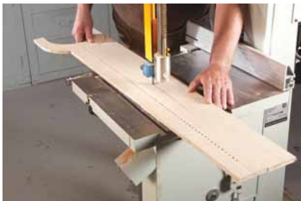
8. Készítsük el a kart! A hossza mentén fúrjuk végig 1 cm-es távolságokban, majd vágjuk ki a megfelelő alakzatra!
