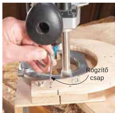
15. A finombeállító segítségével állítsuk közelebb a talpat. Húzzuk meg a szárnyas anyákat és készítsünk egy tisztázó marást, immár teljes mélységben!
