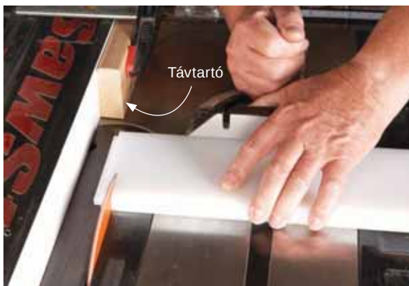
4. Vágjuk le a műanyag mindkét végén kialakított alakzatot! A párhuzamvezetőhöz rögzített ütköző a pontos és biztonságos vágást segíti.
