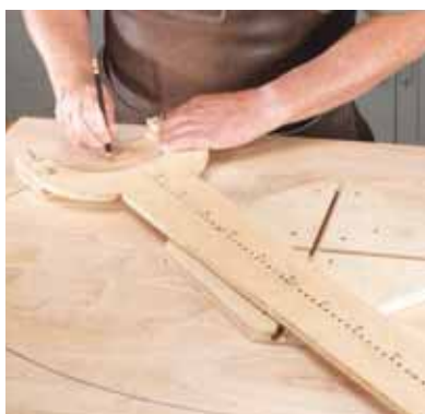
13. Rajzoljuk ki az ellipszist a rajzolótalp segítségével! A leeső részek nagy részét távolítsuk el szalagfűrészsel vagy dekopírfűrészsel!
