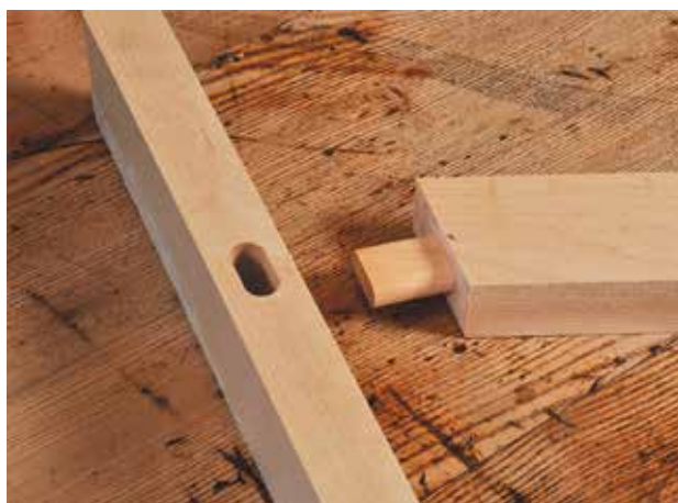
A ferde csap kialakítása ugyanolyan egyszerű, mint az egyenes
