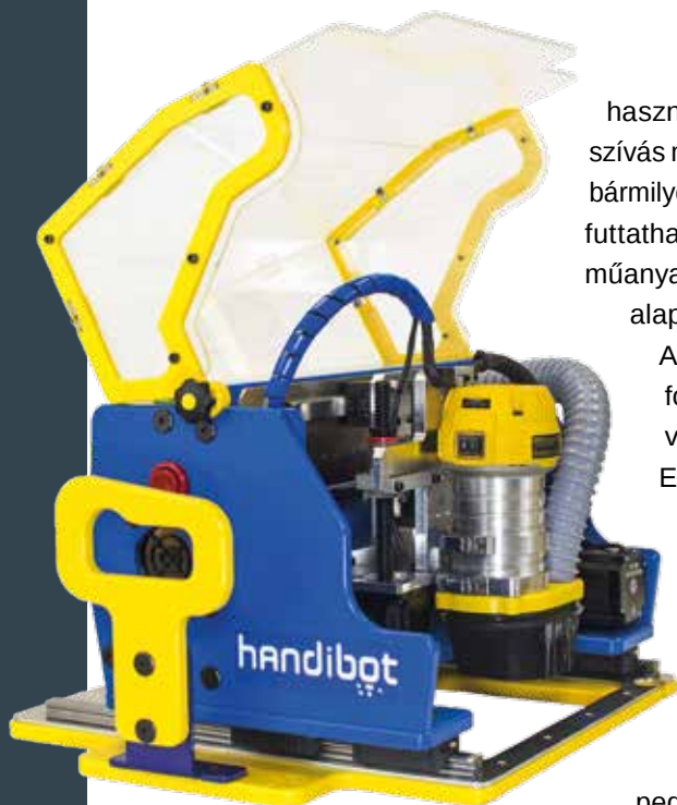
Handibot egy hordozható CNC megmunkáló eszköz
