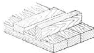
8. ábra: Lapmerekvítés fekvő és álló hevederléccel
