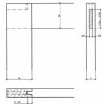
17. ábra: Keret sarokkötés vésett csappal
