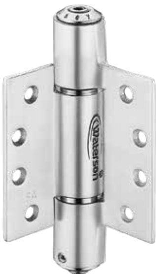
A hat típus egyike, egy mechanikus, 20–90 fok közötti csapódáscsillapított pánt bel- és kültéri ajtókhöz – Waterson
