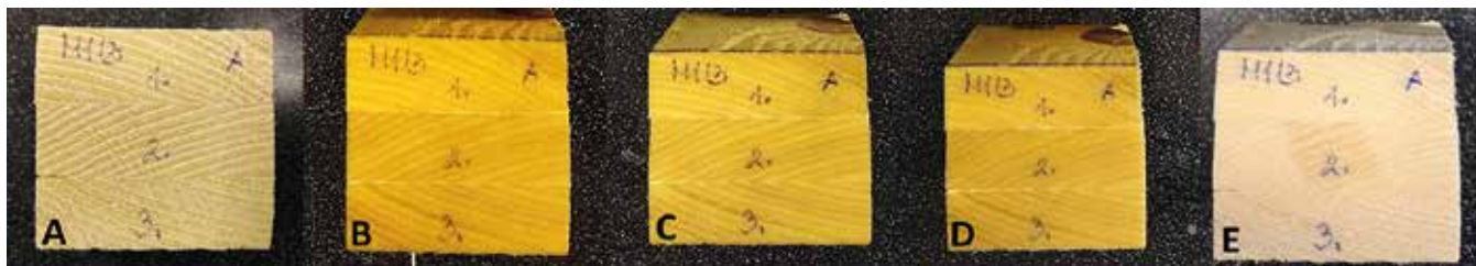
1. ábra: A ragasztott fenyő mintatestek a vizsgálati lépések után. Az A-E számok a fenti felsoroláshoz tartozó lépések után készült képeket jelölik.
