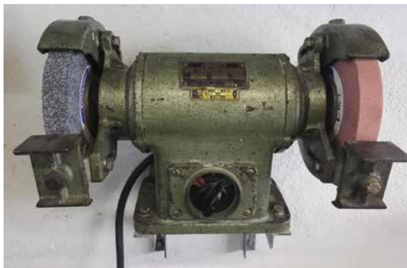
A páros köszörű gyakran a műhely gépeinek korelnöke, ezzel nincs is baj, egy jó állapotú régi gép ma is teljesen alkalmas az egyszerűbb műveletekre. (kondensatorschaden.de)
