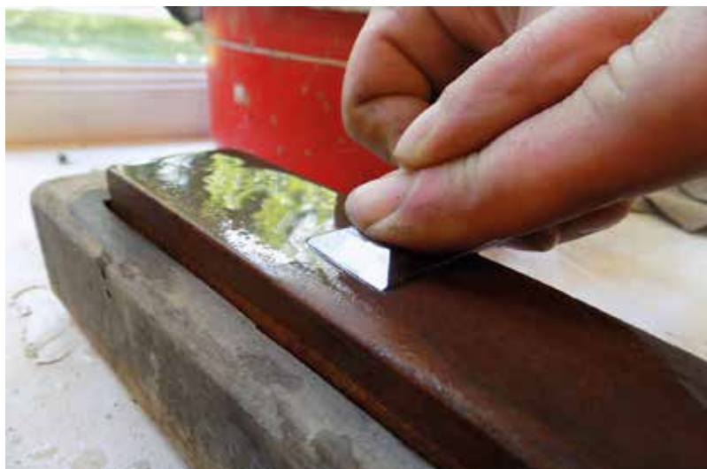
A fenés történhet vizes, vagy olajos kövön, igazán igényes esetben többféle különböző élességű változaton, lépcsőzetesen finomítva a felületet. (a szerző saját felvétele)
