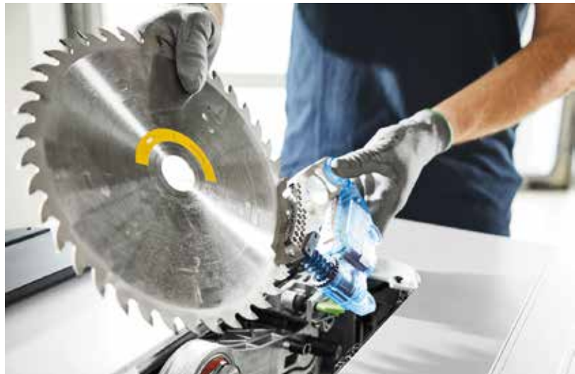
A technológia központi eleme egy patron, mely egy rugó segítségével egy alumíniumtömböt lök a fűrészlapnak, ha az üzemelés közben érintkezésbe kerül az emberi bőrrel.
