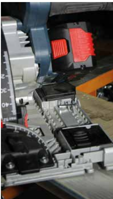
A két illesztést lehetővé tevő kar, illetve az imbuszkulcs helye.
