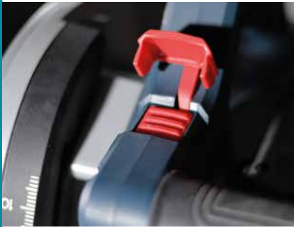
A tengely reteszelése a kis kar alatt kapott helyet.
