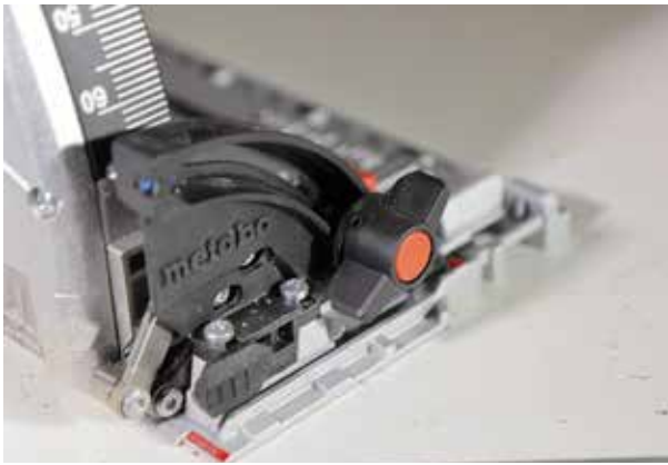
A piros gomb benyomásával a szögállítás mértéke kiterjeszhető -1^\circ és +47^\circ közé.
