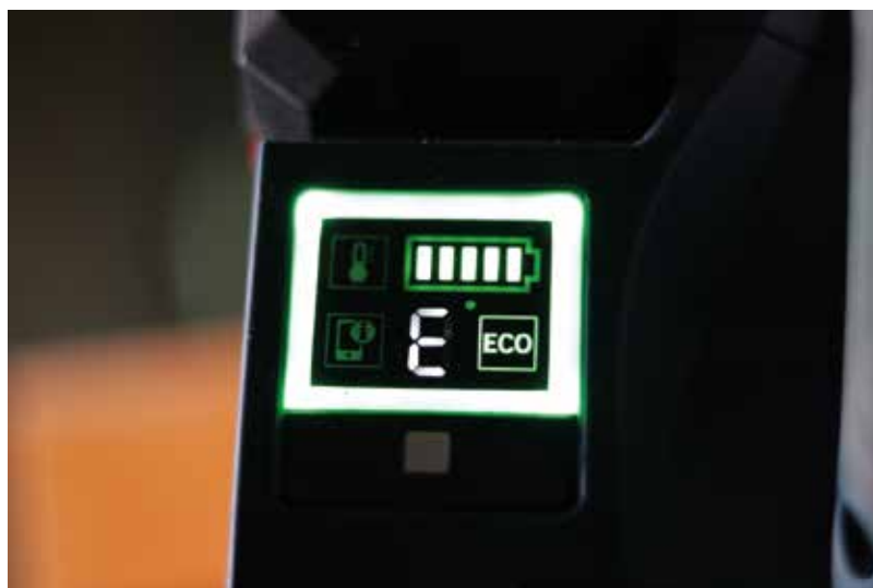
Elektronikus vezérlőegység és információs panel egy helyen
