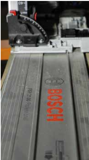
Az FSN sínrendszer. Jól látszik a géptest alatt az eltérő gyártók sínrendszerét fogadó nút
