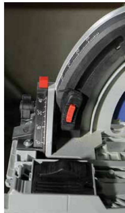
A negatív dőlésszög eléréséhez a piros gombot kell megnyomni.
