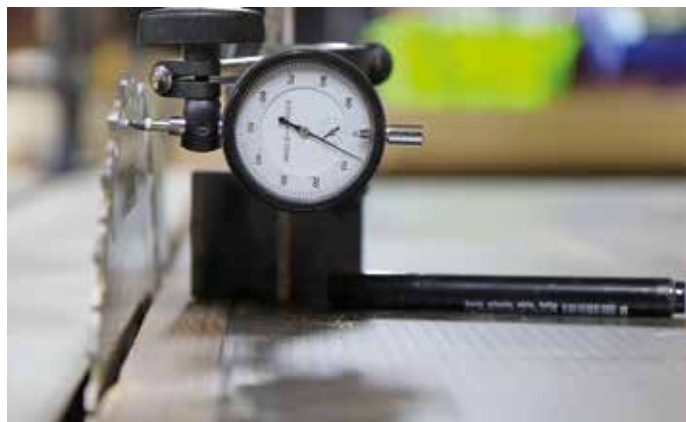
Kiinduló és köztes állapot. 6 század az ütése a lapnak. A kontrollmérés során kiderült, hogy a lapot kell kezelésbe venni.
