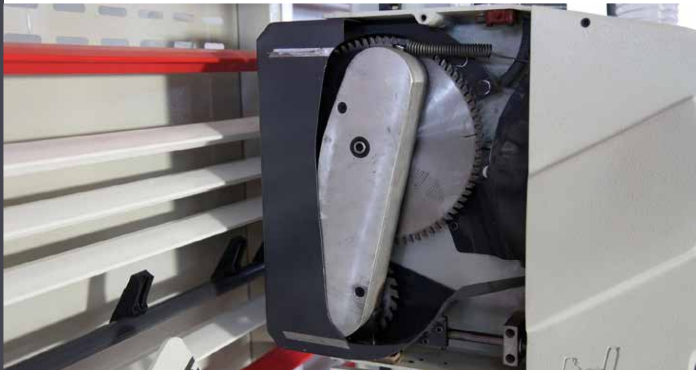
Az elővágóval szerelt gépek hosszabb utat járnak be
