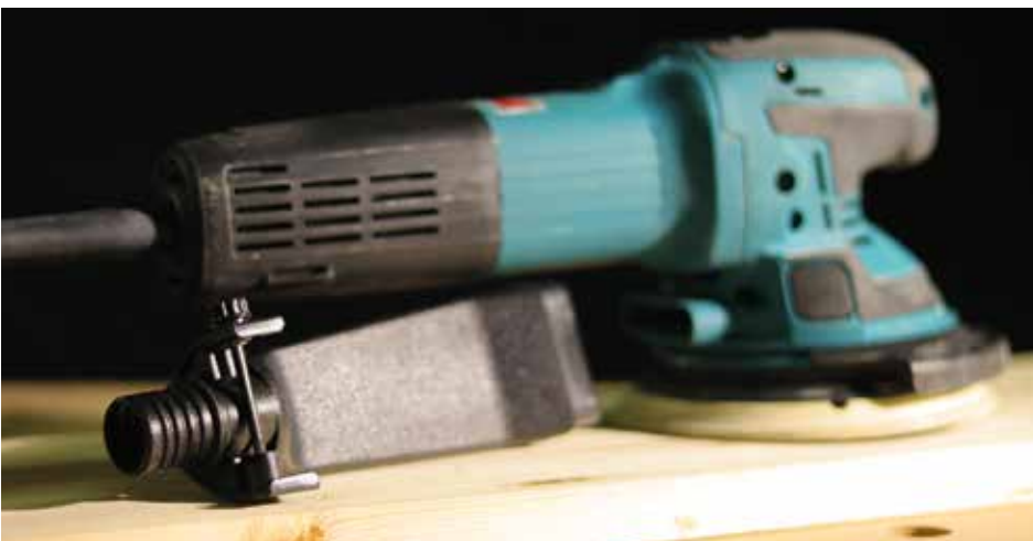
Leszerelt elszívó adapter és a karcsú géptest
