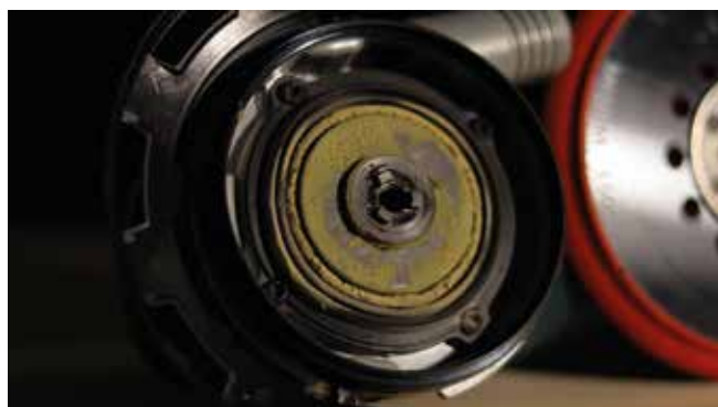
Jól kivethetők a rögzítési pontok a talpon és a géptengelyen.
