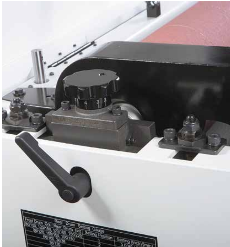
A hátsó henger fogásvételének állítómechanizmusa
