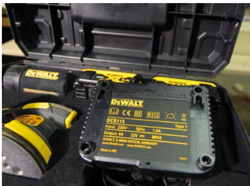
A töltő hátulján megtalálható a falra rögzítést biztosító két fül
