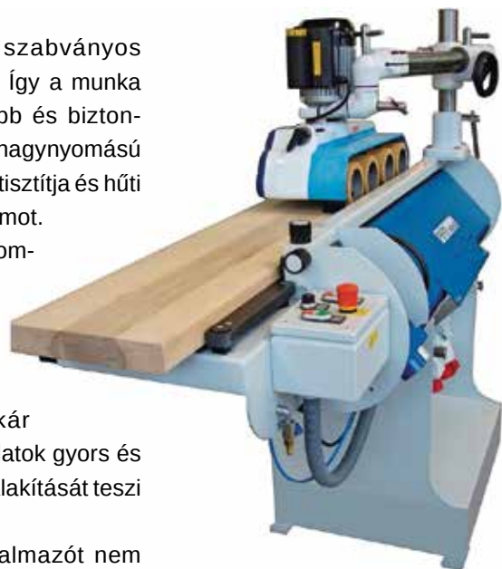
RFM 320 S a kihúzható oldaltámasszal és az előtolóművel.
