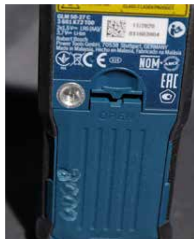
A fedéllyitő mellett kapott helyet a negyedecolós állványmenet
