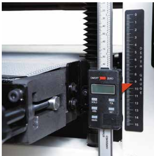
Merevebb asztalt és pontosabb, digitális kijelzőt találunk.
