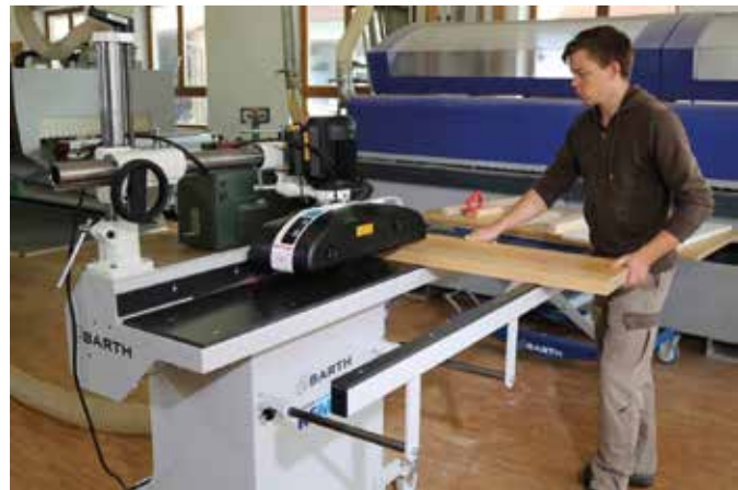
RFM 320 S a kihúzható oldaltámasszal és az előtolóművel.
