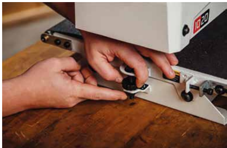
Az asztalnál lévő kis karral a párhuzamosság finomhangolható. Jól látszanak a kis átmérőjű leszorító hengerek. Az olcsó gépeken a rugócsere jobbá teszi a gép tulajdonságait.
