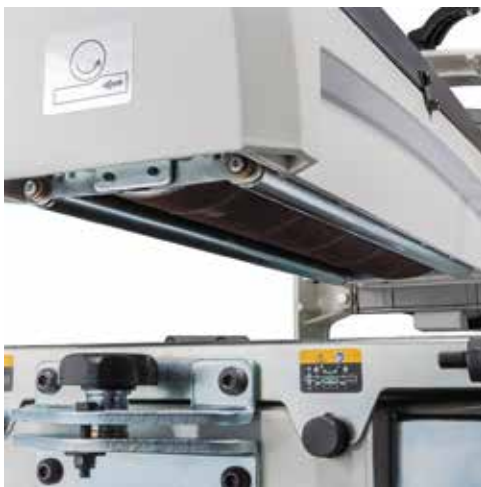
Az asztalnál lévő kis karral a párhuzamosság finomhangolható. Jól látszanak a kis átmérőjű leszorító hengerek. Az olcsó gépeken a rugócsere jobbá teszi a gép tulajdonságait.
