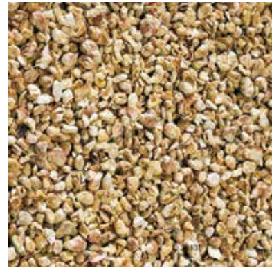
Apró kavicsnak tűnik, de ez kukoricacsutka-granulátum
