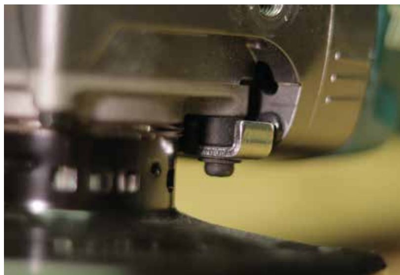
A gép bal oldalán került elhelyezésre a burkolatpozíció gomb
