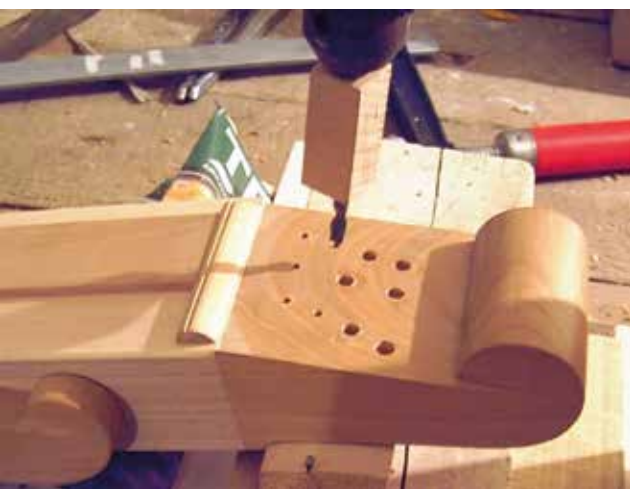
Húrfeszítő csapok kifűrése és beverése
