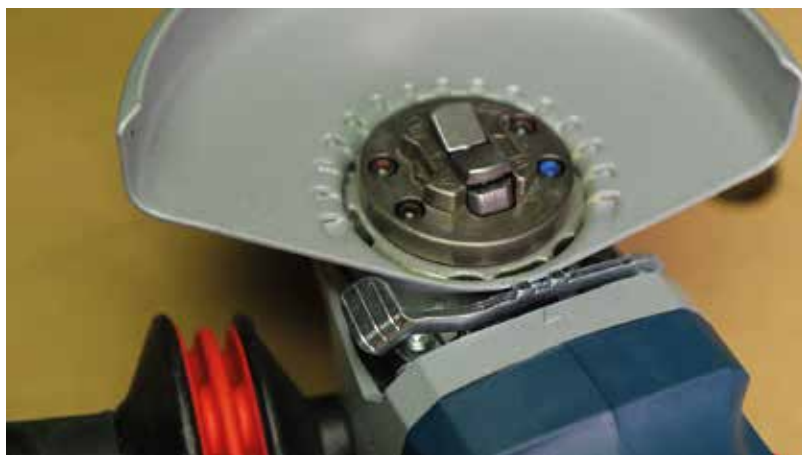
Átfordított védőburkolat, így látható az állítókar és működése
