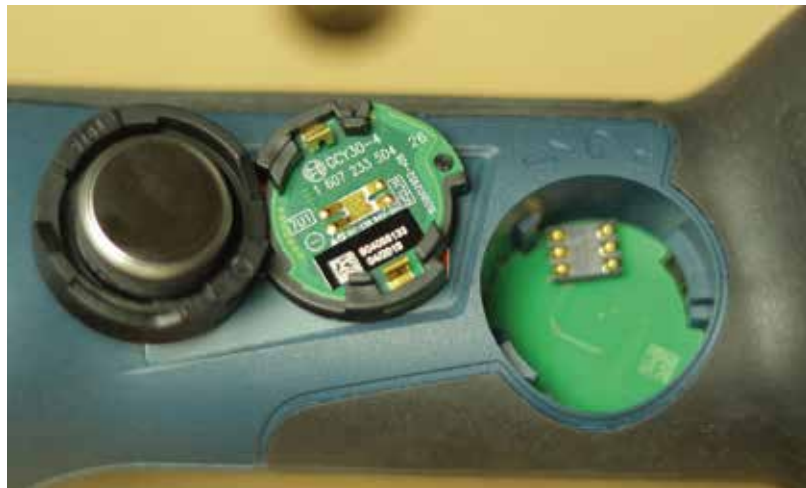
A fekete „tányér” mögött rejtőzik a kommunikációs egység
