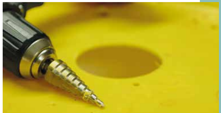
Furatok kialakítása. A vékony műanyagot lépcsősúróval meglepetések nélkül fúrhatjuk meg
