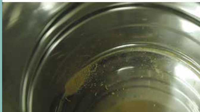
A tartályba jutott por a műhelytakarítást követően
