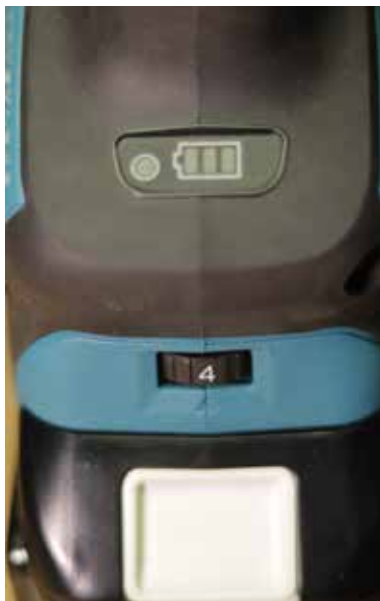
Fordulatszám-állító, valamint töltöttségkijelző és a „nagy nyomatékú mód” visszajelzője.
