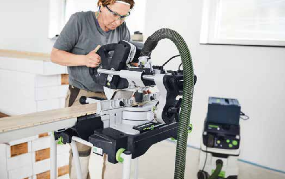
A SYS-PowerStation egységgel a Kapex KS 60 élvágó csatlakoztatott mobil elszívóval 560 élvágást képes elkészíteni egy parkettázás során.
