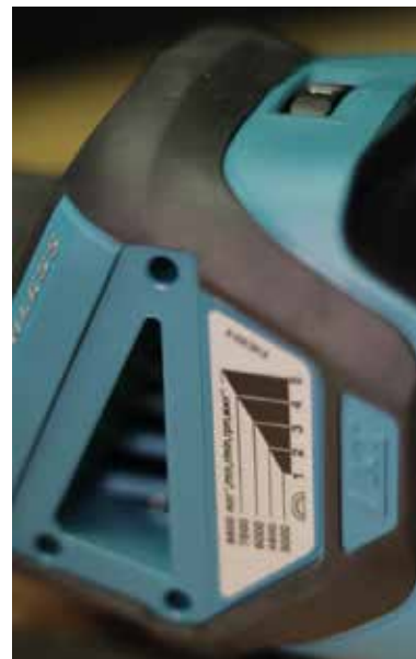
Tájékoztató diagram a fordulatszámokról, felette az eltávolított szűrő visszajelzője.
