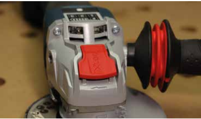
A hajtóműház előlről, egy kis AN 225 beütéssel és az X-LOCK karral
