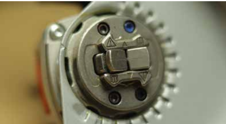
Az X-LOCK befogás mechanikája. A jobb oldalon az edzett karmok rögzítik a vágókorongot
