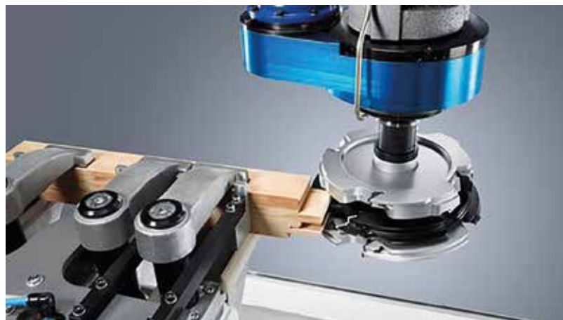
Hagyományos csapós kötés CNC-megmunkálás alkatrészben.
