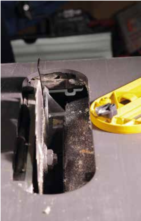
A körfűrészlapot egy strapabíró szövet öleli körbe. Az ajaklemez alumíniumöntvény és egy excenter megoldással könnyen kiemelhető. Egyébként szintezhető is az asztal síkjához.
