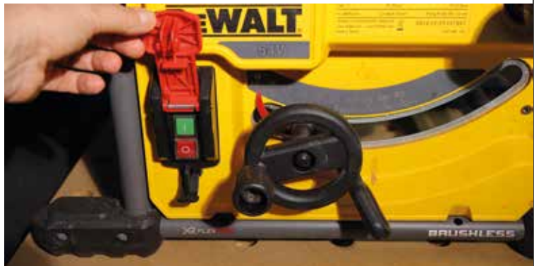
A vese alakú szögűtközt kell eltekerni, hogy a szögvágást ki tudjuk terjeszteni.
