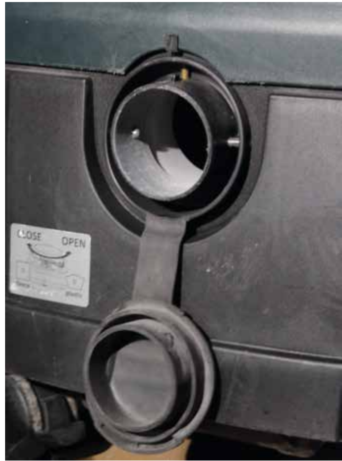
A csőcsatlakozás egy gumidugóval lezárható, amit egy véletlen gépdőléskor fogunk értékelni az autóban.
