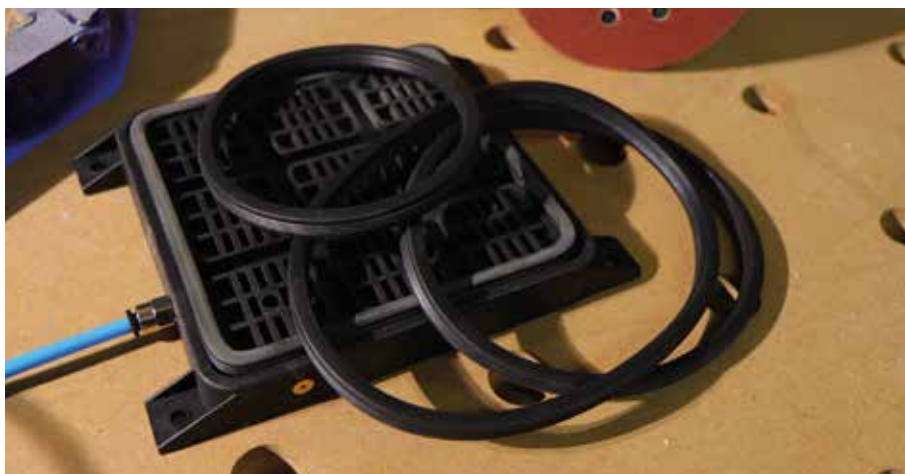
A gumialátétek cserélhetőek, így a tapadófelületet az adott munkadarab paramétereire lehet igazítani.
