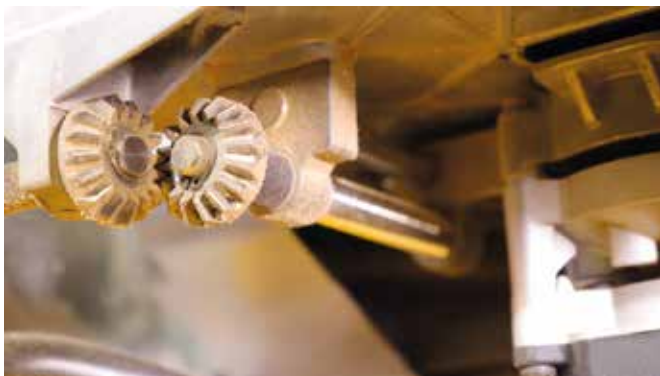
A fűrész emeléséről is acél kúpkerékek gondoskodnak, és külön rudazaton csúszik az aggregát.
