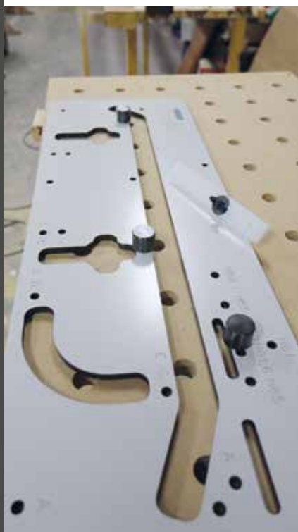
Ütközők elhelyezése a „C” és a „H60”-as pozícióba, 600 mm-es munkalap profiloldali marásához.
