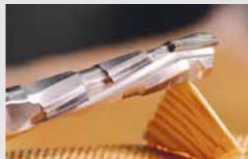
Három él elhelyezkedése. Jól látszik a „terelés iránya”.
