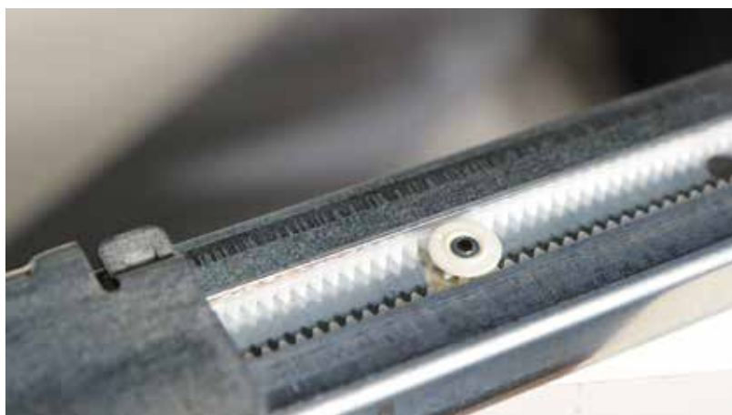
Fogaslécek felelnek a szinkronizálásért.
