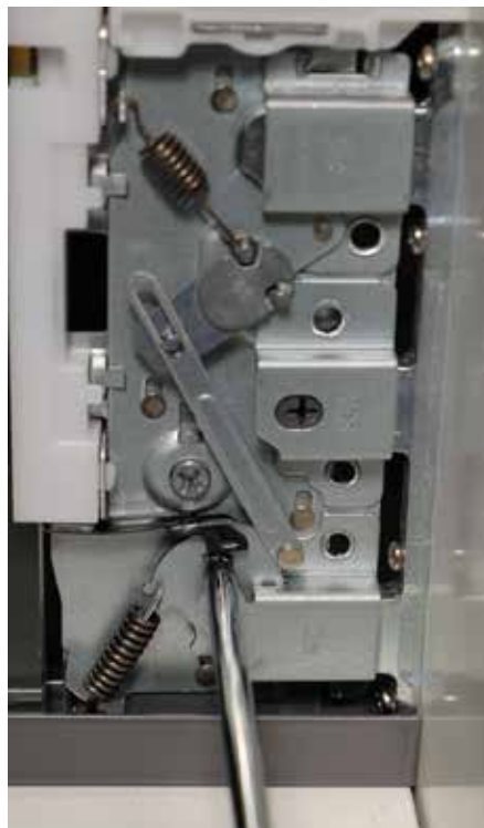
Az előlap leszereléséhez a fekete rugó mögötti keresztornyót kell elforgatni.
