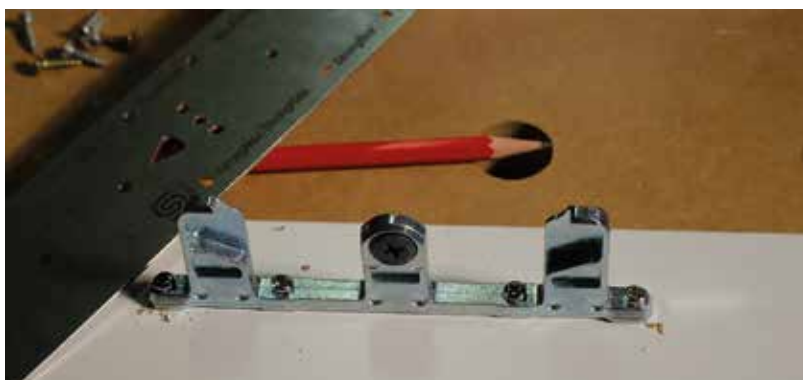
Előlaptartó felszerelése a sablon segítségével és a mellékelt csavarokkal.
