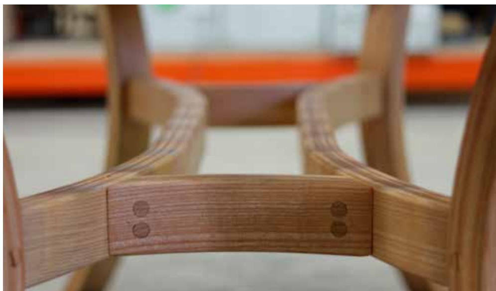
A lábszerkezet minden eleme hajlítva és ragasztva.
