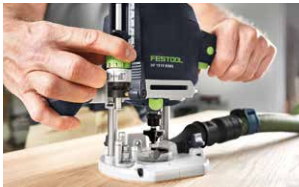
Az OF 1010 R a maráskor biztonságosan felfekszik a vezetőszíne, az eltolható magassági támasznak köszönhetően.
