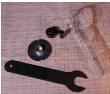
Másológyűrű, elszívóburkolat, redukálóhüvely, befogópatron. A villáskulcs inkább dísz tárgy...
