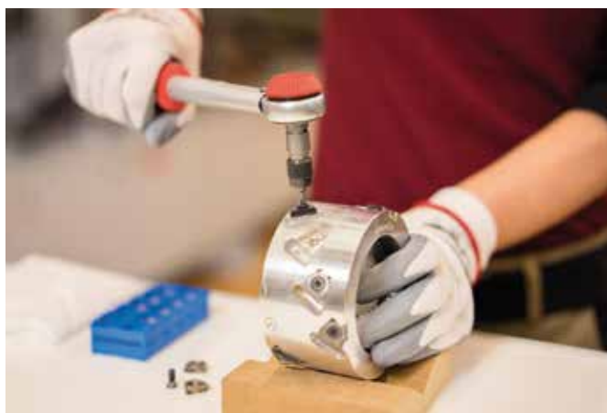
A Diamaster WhisperCut speciálisan kifejlesztett gyémánt vágóélei a Leitz-szervizekben utánéleztethetők. Az elhasználdott gyémántélek cserélhetők. (Fotók: Leitz)
