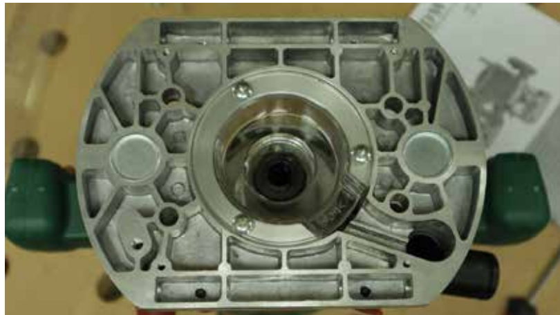
A talp belseje. Jól kivehető az elszívás kialakítása a darabfogóval és az öntött merevítések.
