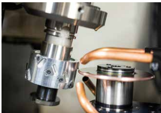
A Diamaster WhisperCut speciálisan kifejlesztett gyémánt vágóélei a Leitz-szervizekben utánéleztethetők. Az elhasználdott gyémántélek cserélhetők. (Fotók: Leitz)
