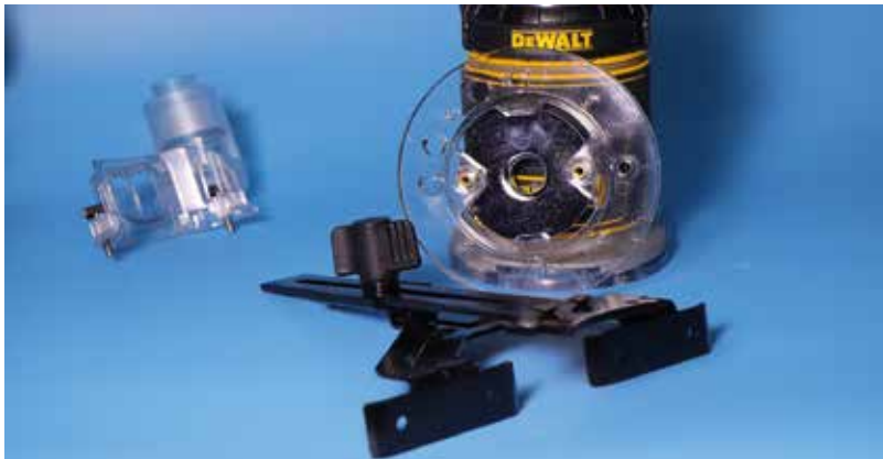
A négyzet alakú átlátszó talpbetét cserélhető kör alakúra is. Négy csavart kell oldanunk, és a cserét követően már a mellékelt 17 mm-es másológűrűt is tudjuk használni.
