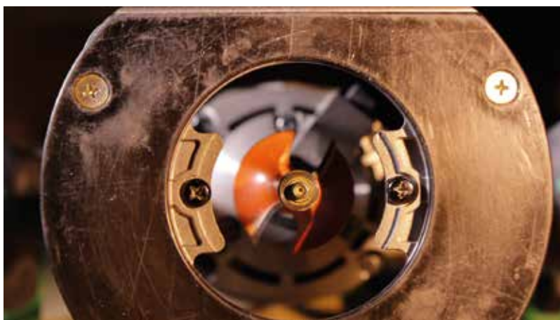
A két Philips csavart javaslom, hogy cseréljük le a belső kulcsnyílására.
