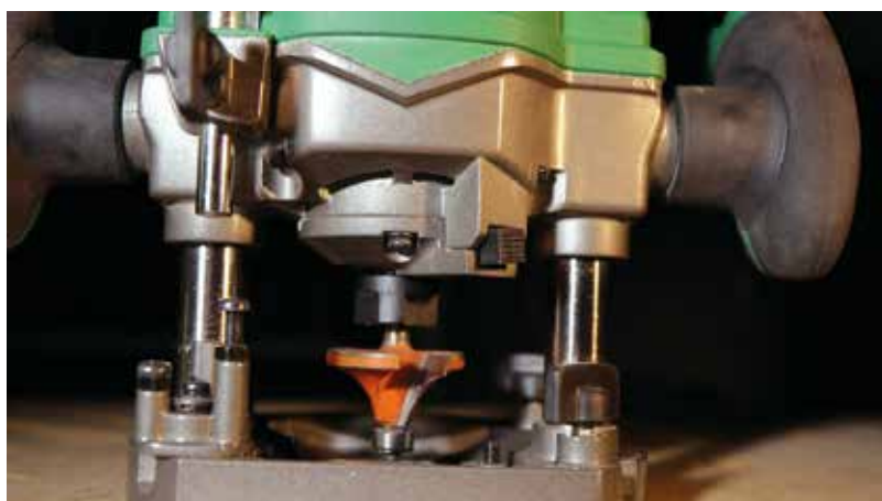
Semmi sincs túlgondolva. A revolverütköző és a tengely reteszelése is egy oldalra került.
