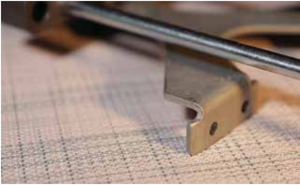
Stabil, nem lötyögő párhuzamvezető, némi fejlesztést mi magunk is végezhetünk, a nagyobb felfekvés érdekében.
