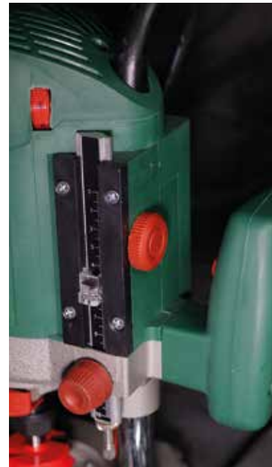
Első ránézésre komplikált, de használat közben nagyon hasznos mélységbeállítást lehetővé tevő rendszert kapunk.
