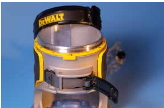
A kisebbik talp és a mélységállító gyűrű. Látszik a fózolt horony a talp tetején.
