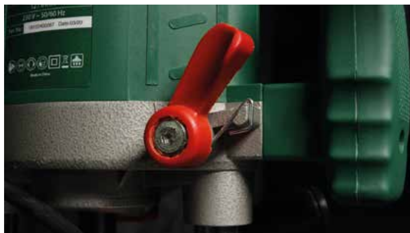
A rögzítőkar és a markolat kialakítása.
