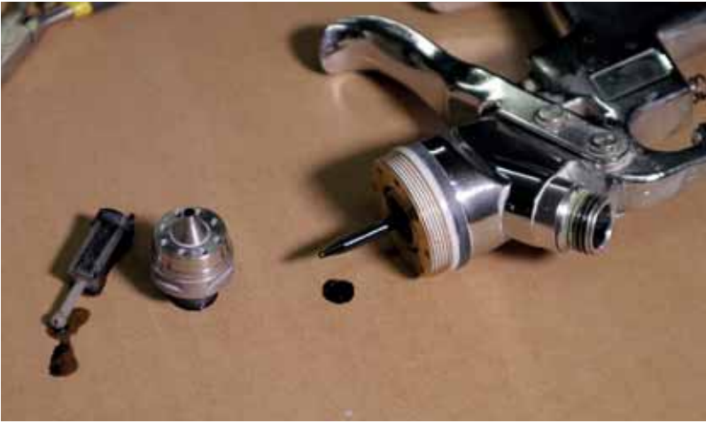
A legtöbb esetben a szétszerelés után ezeket az alkatrészeket mossák el, illetve a pisztoly belsejét.
