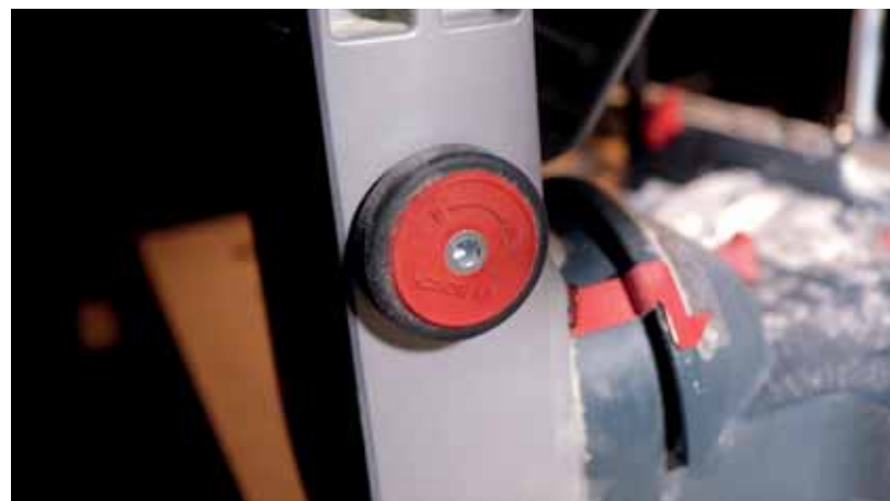
Szerelőkulcs és szerszám nélküli lapcseréhez mellékelt rögzítőcsavar.
