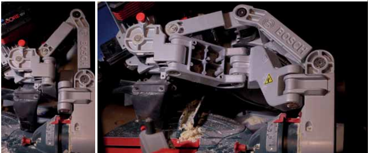
A csuklós mechanizmus összecsúszott és teljesen nyitott állapotban.
