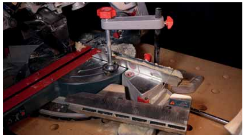
Leszerelt steller és a munkadarab-rögzítő.
