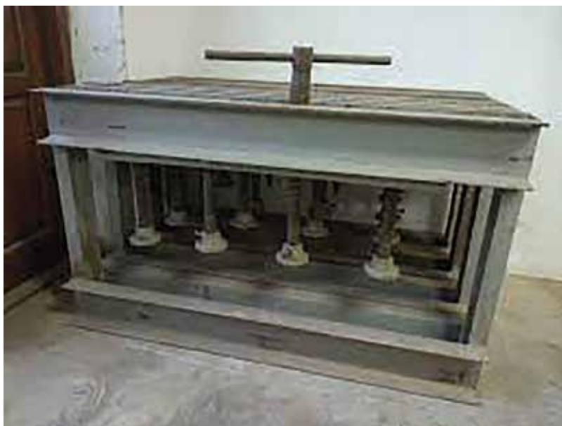
„I” és „U” tartókból készített enyvezőbakok.
