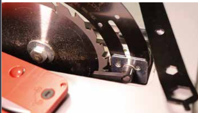
A hasítóék kihúzott állapotban. Jól látszik a stiftes pozicionálás és az excenteres kar.
