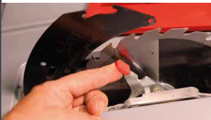
A szerszámcsere megkönnyítésére egy retesz lesz a segítségünkre.
