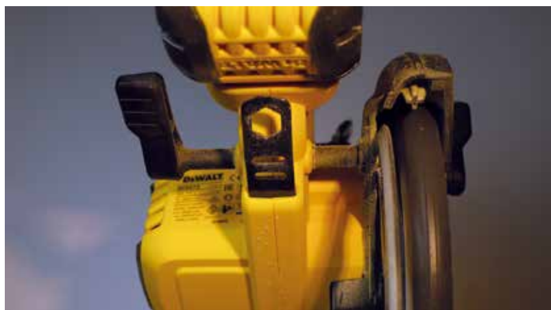
A mélységállító kar mellett jobbra a tataban van elrejtve a szerszámkulcs is.
