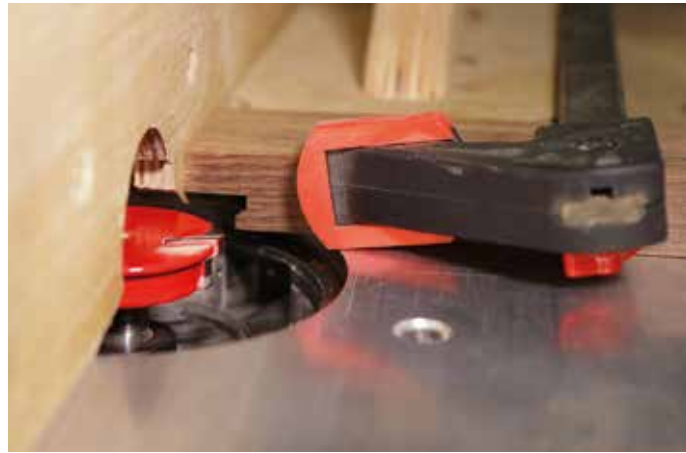
Keskeny csapos alkatrész marása. A tolófa és a rögzítés fontos.
