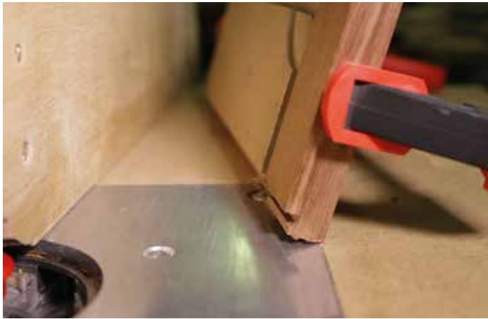
Keskeny alkatrészek esetében tolófát és rögzítést is kell alkalmaznunk.
