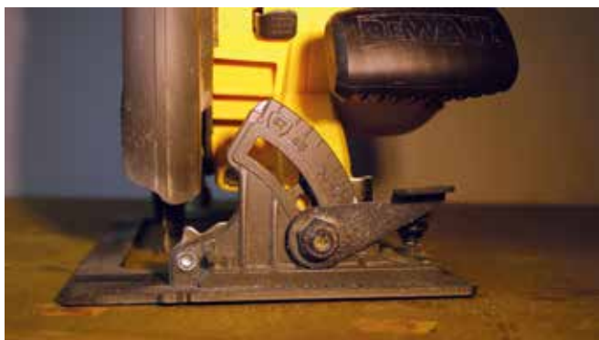
Öntvényből készült szögállító, amely cserélhető is.
