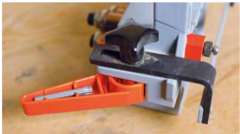
Excenterkar a bittartóval, és a rögzítéshez szükséges fekete kar.
