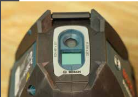
A fedetlen 256x192 pixeles érzékelő, illetve a 640x480 pixeles kamera.
