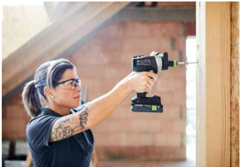
És ha a csavarozásnál veszélyes helyzet alakulna ki: az elektronikus KickbackStop funkció minimalizálja a kockázatot, hogy a fúró-csavarozó hirtelen megakadása a csuklót kicsavarja.
