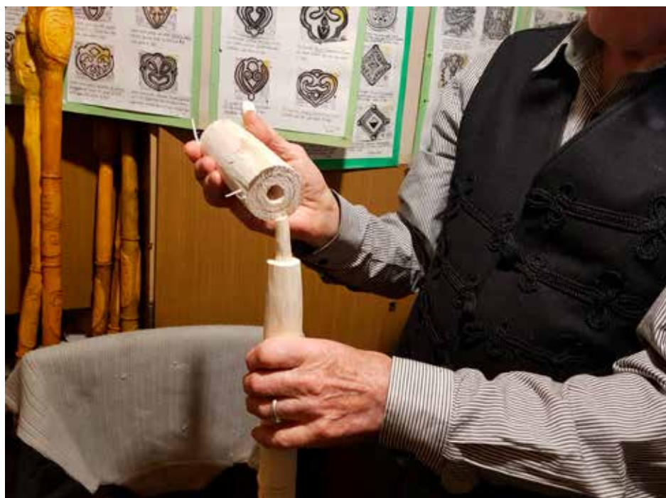
A pásztorbot szárát csapolással illeszti a fejbe.
