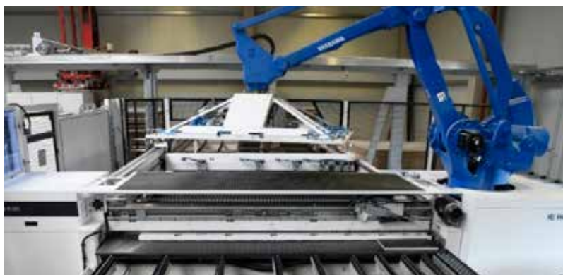
A Horatec GmbH Losgröbe-1 (egydarabos széria) technológiai sorában a vágásokat két SAWTEQ B-320 flexTec típusú Homag robotfűrész végzi.
