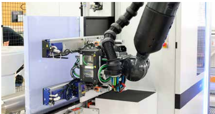
Robusztus vákuumos megfogók gondoskodnak a precíz mozgatásról és a pozicionálásról.
