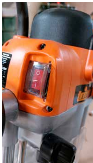
A repülőrajtot elfelejthetjük. Viszont a kapcsolóba jutó port duplán igyekszik kizárni a gyártó.
