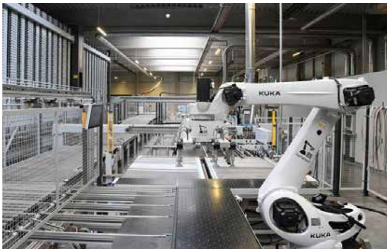
Az élzárás automata körforgásban zajlik, robottal támogatott be- és kiadagolással (Horatec GmbH, Németország).
