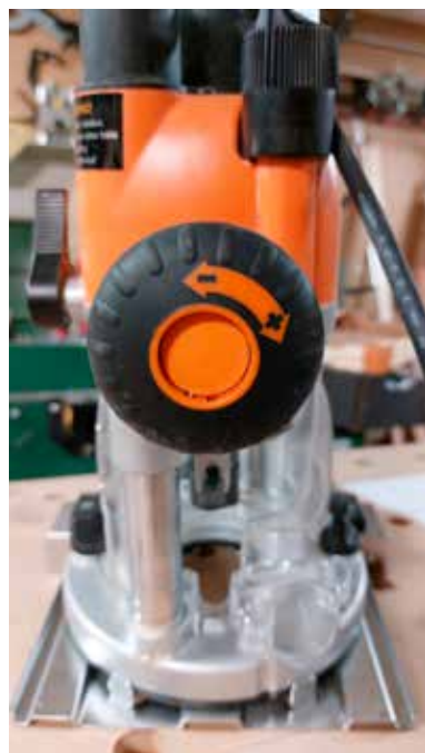
A marómélység hagyományos beállításához egy módváltó gombot is be kell nyomnunk.
