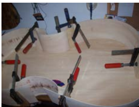
Formára hajlított káva rögzítése a tőkékhez
