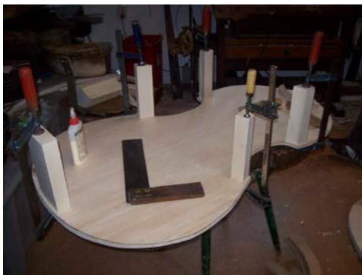
Nagybőgő hátlapjára a tőkék felragasztása
