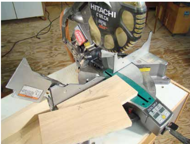
A digitális kijelző segítségével tizedpontosan vághatunk
