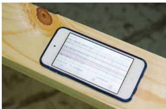
► Mobiltelefon alkalmazása fűrészáru rezgéseinek a mérésére (Franca és társai, a szerzők engedélyével).
