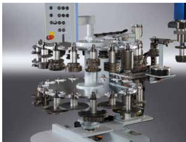
► 6. kép: CNC-gép szerszámtárolója és a páros-végprofilozó gépen egy perc alatt cserélhető körkéses marószerszám
