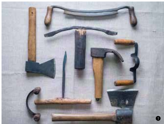
▶ A gyalu előtti/nélküli korszak szerszámjai: fejsze, szekerce, kapacs, vonókések, fűrő, hornyoló kacor. A készlethez, fűrész is tartozik!
