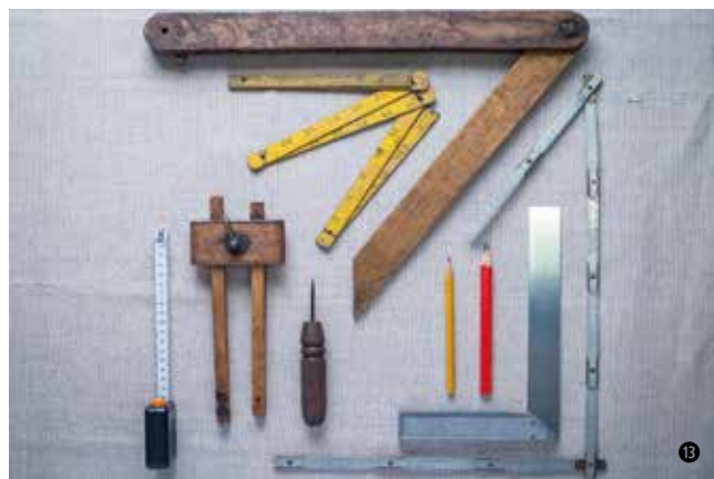
▶ Mérő és rajzeszközök: Derékszög, sáskaláb, párhuzamvonalzó (streihmász), zoll (hüvelyk), és cm beosztású mértékek (collstok, centi), rajztű (spicpór), ceruzák.
