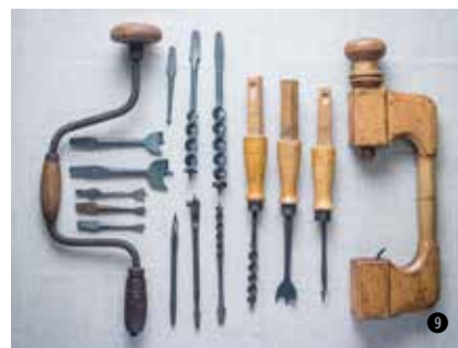
▶ Fúrók I. Fafurdancs és betéjei balról: Douglas-, központ- és szegfúró. Az acélfurdancs és betéjei: süllyesztő fúró és Douglas-fúrók fent, központfúrók középen, szegfúró, állítható központfúró és Douglas-fúró lent.
