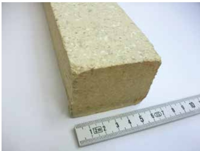
► 5. ábra: purenit rúd ( \lambda=0,07 \text{ W/m}^2\text{K} , gyártó: Puren GmbH)
