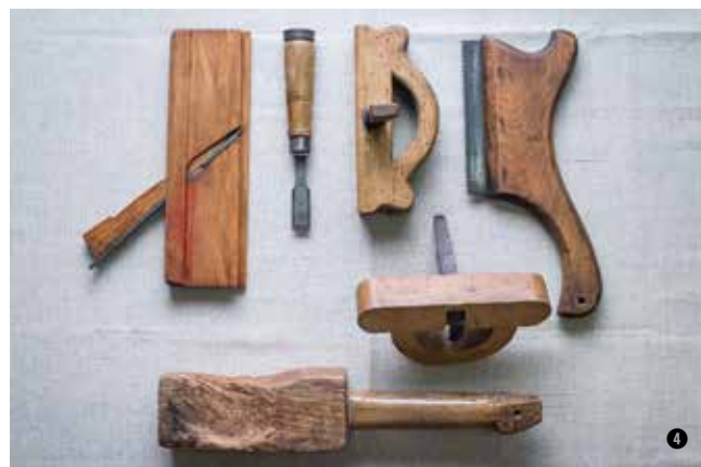
▶ A hevederezés (grótolás) szerszámjai: hevederfűrész (jobbra), laposvész és bunkó a hevederárok kinagyolására, alap-, vagy fenékgyalu a hevederárok végső kitisztítására (a hevederfűrész-től balra fölülről és a kés felől nézve), gerincgyalu, a hevederléc fecskéfark-formájának kigyalulására (balra fent).
