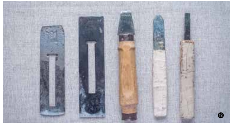
▶ Segédeszközök: kiszolgált gyalukések kisebb igazításokhoz, csap- és lábvégek letörésére (fózlására), nyeles pengék csapok megbontására, stb.
