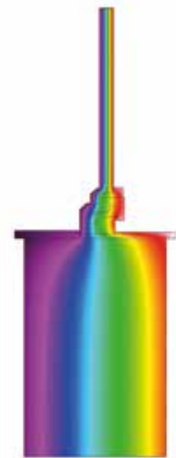
▶ 2. ábra: homogén fal középsíkjába épített ablak
