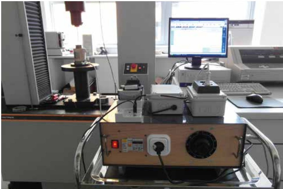
► 2. ábra: az egyedi tervezésű fűtési és szabályzó mérőrendszer mérés közben.
