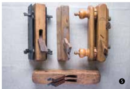
▶ Tagozatgyaluk: árok- (nut)gyalu (balra fent), egyszerű alj- (falc)gyalu (középen fent), állítható oldal- és mélységhatárolós alj- (falc)gyalu előmetsző késsel (jobbra fent), és hosszcsap- (féder)gyalu lent.
