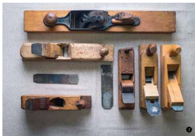
▶ A gyaluk alapformái. Ívelt élű nagyológyalu és kése (baloldalt, alul) és egyenes élű simítógyaluk egyes, vagy kettős éllel.
